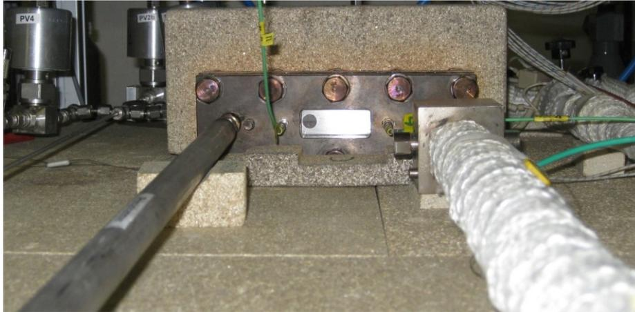
Abb. 3-31: Reaktordesign 1.1 mit Primär- (links) und Sekundärkammer (rechts).
