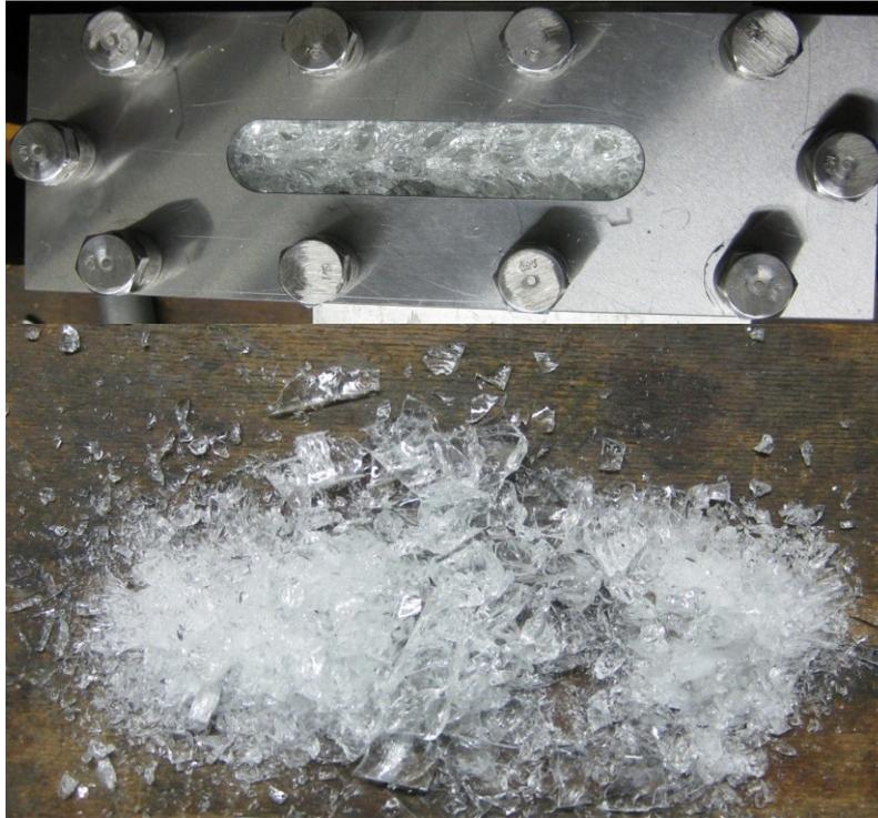
Abb. 3-39: Zersprungenes Sichtfenster vor (oben) und nach (unten) der Entnahme aus der Deckelplatte.
