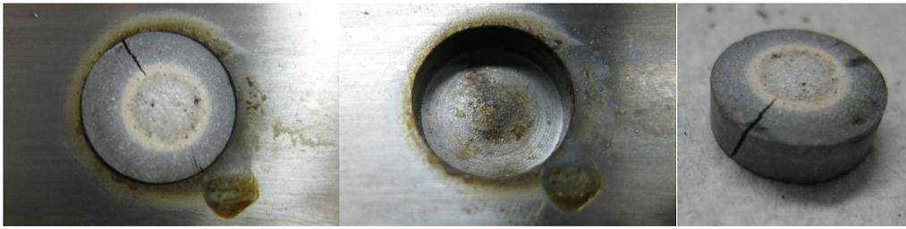
Abb. 3-27: Keramikprobe und dessen Fassung im Reaktor nach der Laserbestrahlung.
