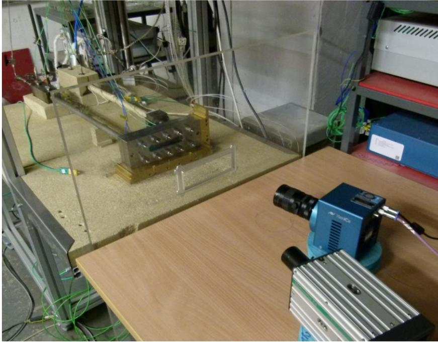
Abb. 3-42: Reaktordesign 2.1 mit beiden angrenzenden Kammern (hinten), Amiran-Schutzscheibe (mittig) und Infrarot- und Hochgeschwindigkeitskamera (vorne).
