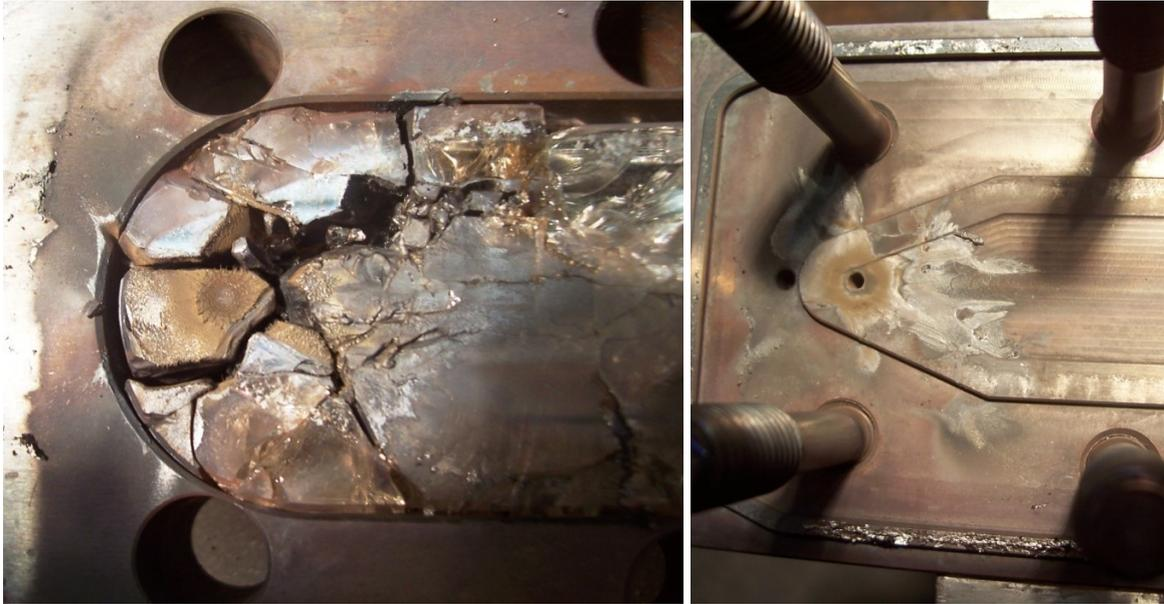
Abb. 4-99: Gaseinlassbereich des Reaktorfensters (links) und der Bodenplatte (rechts) nach der Gasphasenexplosion bei  $p_0 = 40$  bar.
