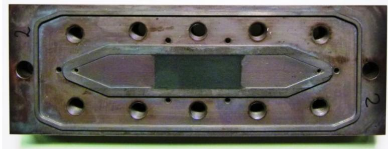
Abb. 3-48: Reaktorbodenplatte mit Katalysatorbeschichtung.
