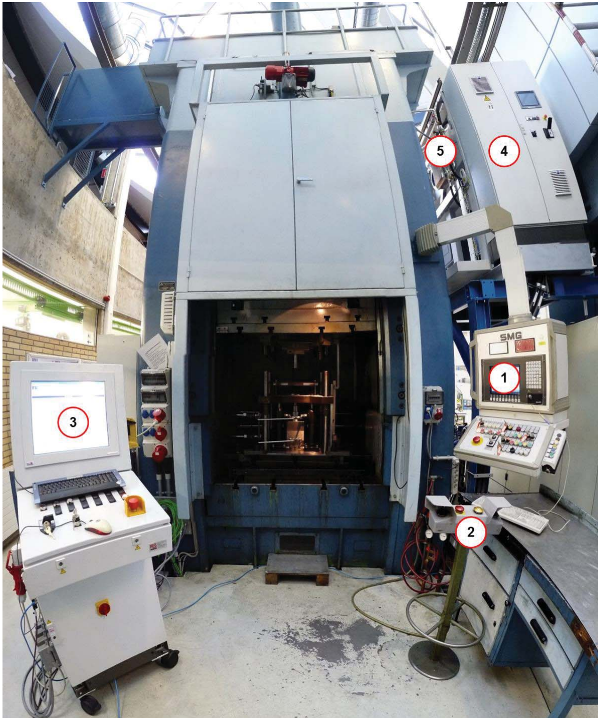
Bild 5.11: Vorderansicht der hydraulischen Versuchspresse vom Typ HZPUI 300/300-1300/100 des Herstellers SMG mit eingebautem Werkzeuggestell für kombinierte Fließpressprozesse mit bewegter Matrize und des Hydraulikaggregats (1 – Bedienpult Pressensteuerung, 2 – Zweihand-Bedienung Presse, 3 – Schaltschrank und Bedienpult Werkzeugsteuerung, 4 – Steuerung Hydraulikaggregat, 5 – Hydraulikaggregat)
