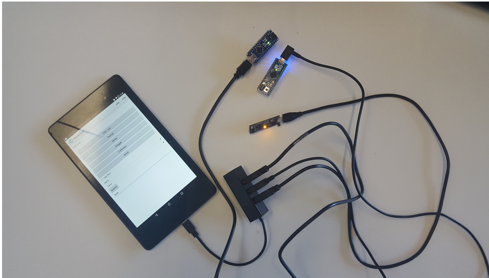
Abbildung 3.1: Gezeigt wird der Anschluss von einem IMUduino (unten), einem Arduino Micro (mittig) und einem Arduino Nano (oben) über einen USB-OTG Hub an das Google Nexus 7 Tablet.
