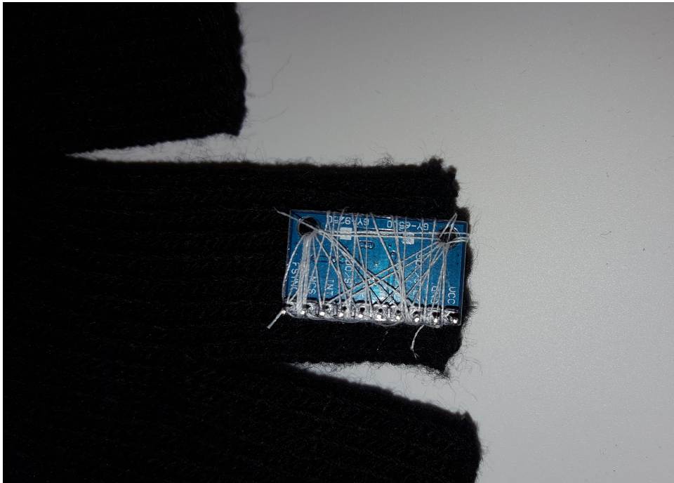
Abbildung 3.7: Zu sehen ist die Befestigung der IMU am Zeigefinger. Sie wurde fest mit dem Handschuh, durch Nutzung der Pinzwischenräume und Chipausparungen, vernäht, um einen festen Sitz zu garantieren.
