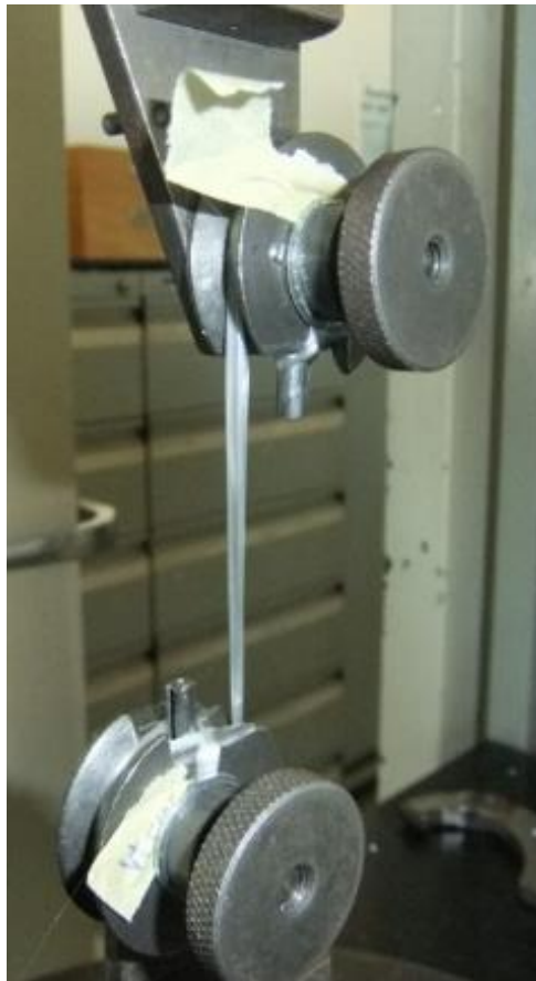
Abbildung 5.7: Zugprüfung eines einzelnen Rovings angelehnt an DIN EN ISO 6892-1:2009-12
