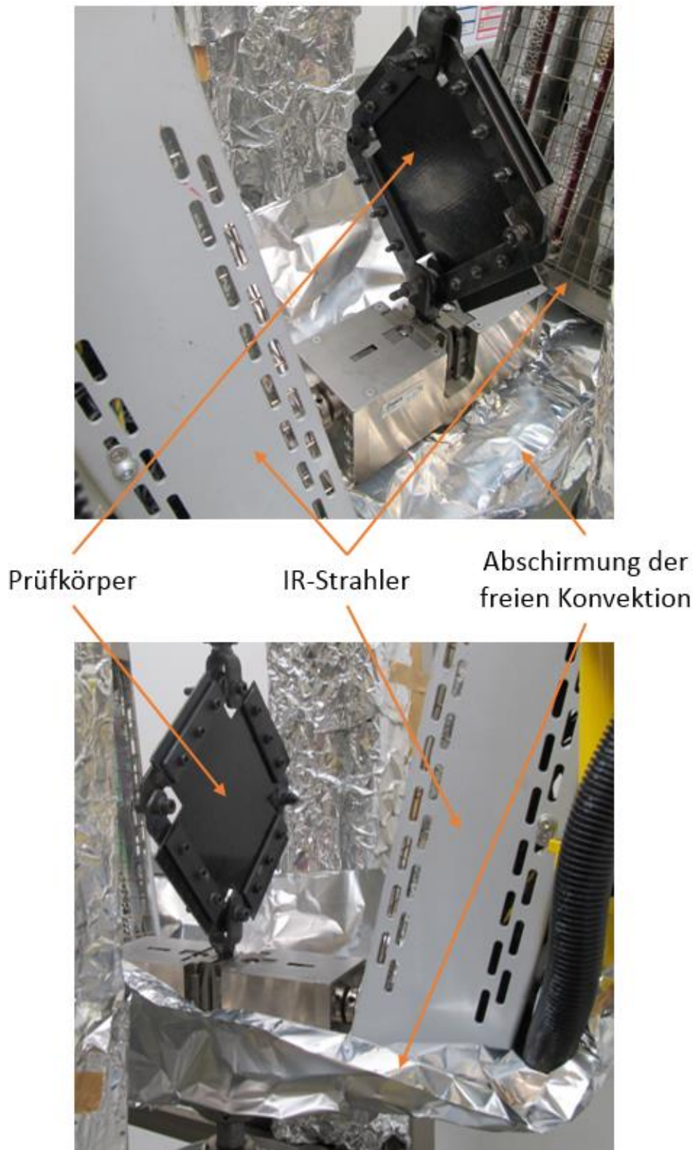
Abbildung 5.8: Versuchsaufbau mit Abschirmung der freien Konvektion
