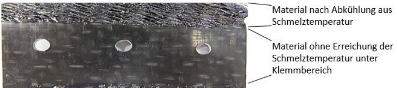
Abbildung 5.29: Klemmbereich des Prüfkörpers nach Scherversuch
