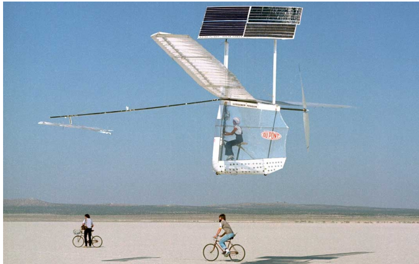
Abb. 2.4: Der Gossamer Penguin im Flug (Bild: NASA). Das Flugzeug war noch nicht in der Lage den Bereich des Bodeneffekts zu verlassen. Der Fahrradfahrer auf der Abbildung verdeutlicht die Fluggeschwindigkeit.
