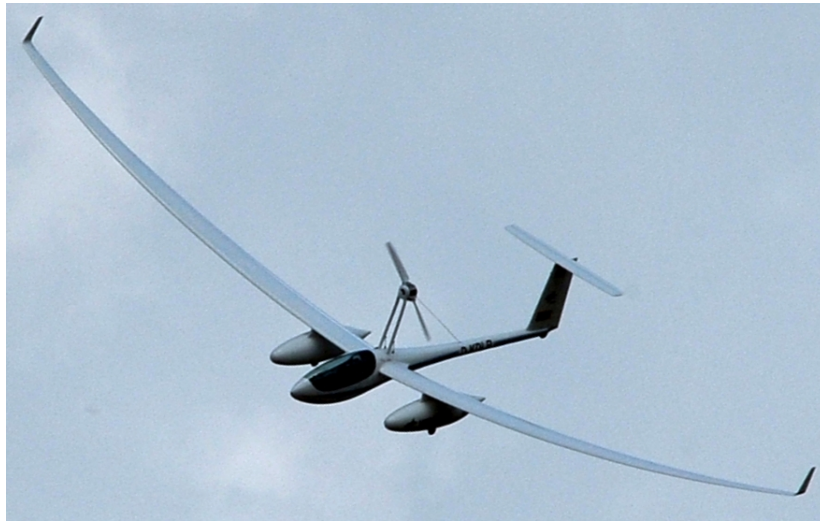
Abb. 2.7: Die Antares H 2 ist eine modifizierte Antares von Lange Aviation , die vom Deutschen Zentrum für Luft- und Raumfahrt für die Erprobung von Wasserstoff/Luft-Brennstoffzellen eingesetzt wird. Bild: DLR
