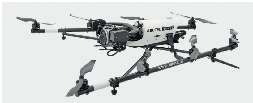
Abb. 2.2: Der Oktokopter Asctec Falcon 8 der Firma Ascending Technologies GmbH [8]. Dieses Klein-UAS wird zum Beispiel für die Erstellung von Luftaufnahmen bei Sportereignissen verwendet.
