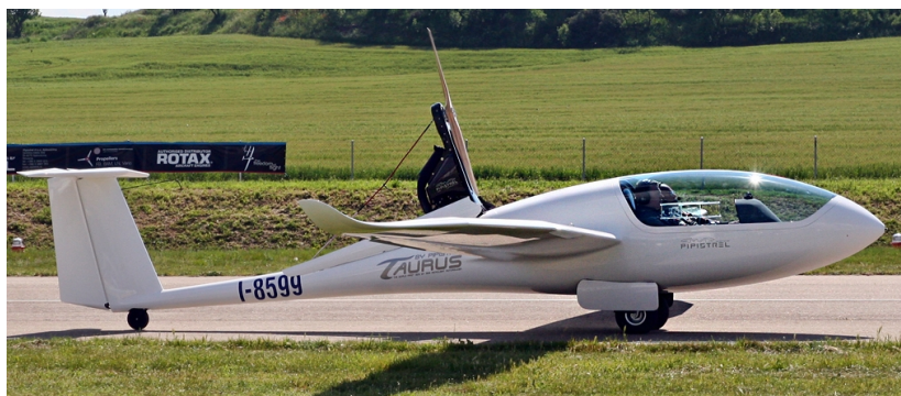
Abb. 2.6: Der Taurus G2 des slowenischen Herstellers Pipistrel ist das erste zweisitzige Flugzeug mit E-Antrieb, das in einer (Klein-)Serie gebaut wird. Bild: Curimedia
