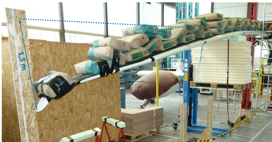
Abb. 4.21: Belastungstest des Flügels mit Zementsäcken (Abfanglast bei V_A ). Die maximale Durchbiegung an den Flügelenden beträgt ca. 1,5 m.
