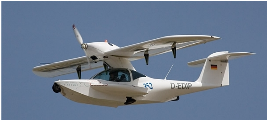
Abb. 3.5: Amphibienflugzeug S-Ray der Firma DoTec . Die unkonventionelle Motorposition dient der Auslegung als wassertaugliches Flugzeug und nicht der Effizienzverbesserung. Bild: DoTec
