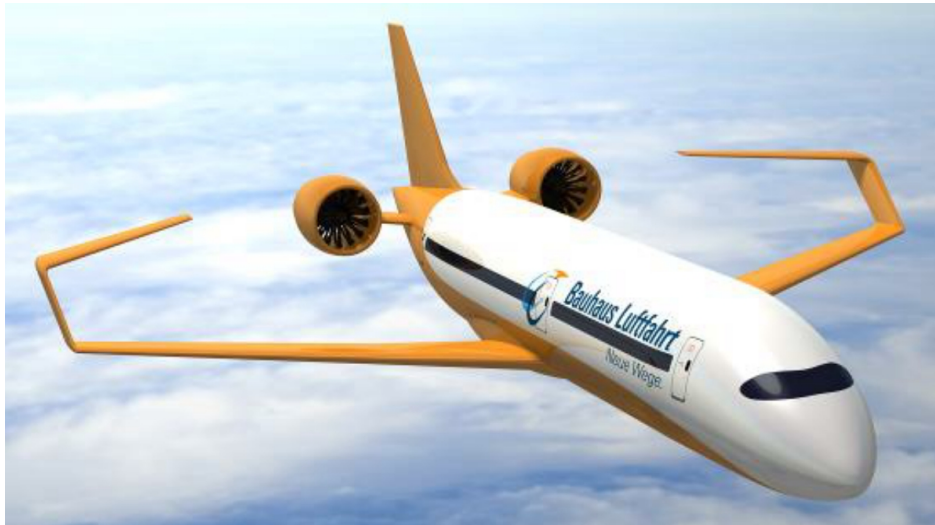
Abb. 1.2: Das Ce-Liner - Konzept des Bauhaus Luftfahrt e. V. (aus [50]) mit einer Passagierkapazität von bis zu 189 Plätzen und elektrischem Fan-Antriebssystem.
