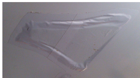
(f) NACA-Lufteinlass abgeklebt
