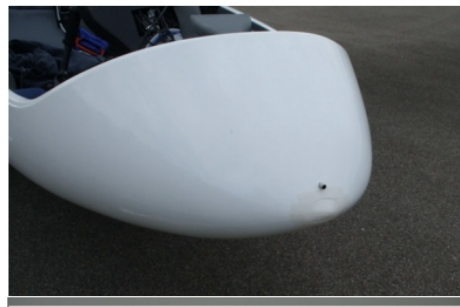
(b) Lufteinlass vorne abgeklebt
