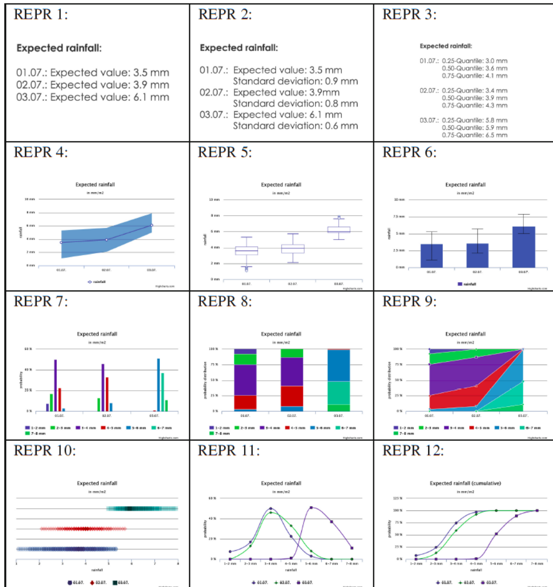
Abbildung 2.6.: Die Abbildung zeigt zwölf ungewisse Visualisierungen am Beispiel von erwartetem Regenfall über drei Tagen. 1–3: Textuelle Darstellungen, 4: Liniendiagramm mit Flächendiagramm, 5: Boxplot, 6–7: Säulendiagramm, 8: Gestapeltes Säulendiagramm, 9: Flächendiagramm, 10: Getönte horizontale Balken, 11–12 Funktionsgraphen
