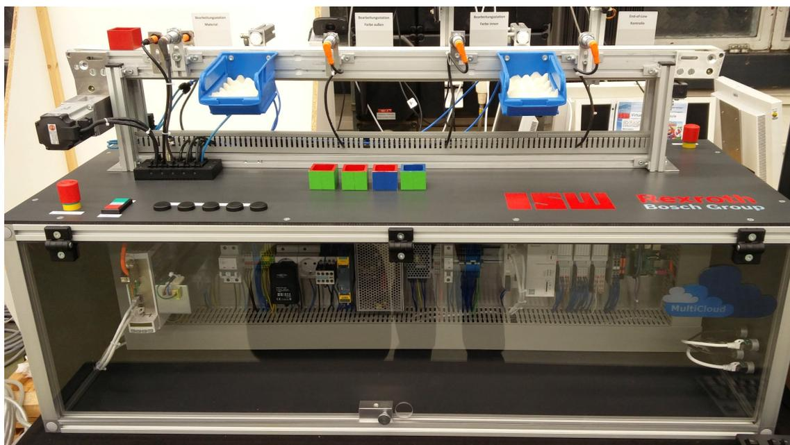
**Abbildung 6.4:** Aufnahme des Modells, das für Ausstellung genutzt wird. Das Material wird über das Gewicht bestimmt, die Farben mithilfe von Kameras.
