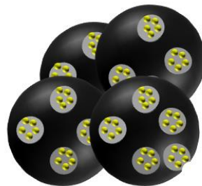
Abbildung 11: Schematisches Modell eines makroporösen Aktivmaterials mit einem Kohlenstoffträgermaterial (schwarz) und in die Poren eingelagertem Schwefel (gelb).
