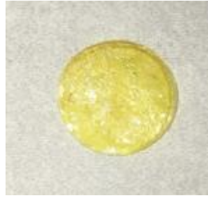
Abbildung 91: Ein gezyklelter Separator einer DMTS/SPAN-basierten Zelle. Die Gelbfärbung weist auf die Bildung von Schwefel oder Poly(sulfiden) hin. [93]
