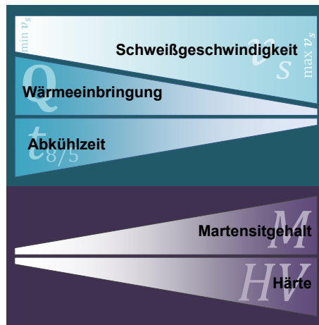
Abb. 3-11: Wechselbeziehung zwischen Schweißparametern und Eigenschaften der Schweißnaht
