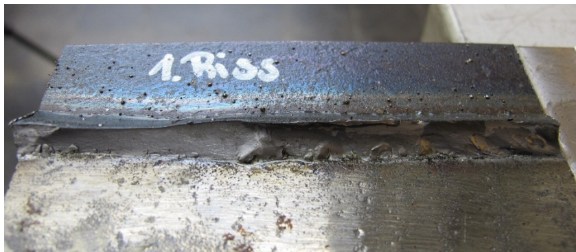
b) Topografie der Nahtbruchfläche
