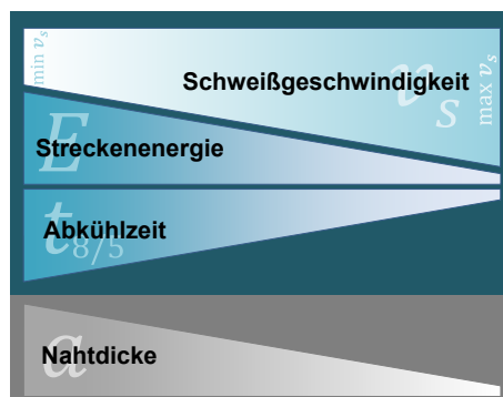
Abb. 8-8: Einfluss der Schweißgeschwindigkeit v_s auf die Streckenenergie E , die Abkühlzeit t_{8/5} und die Nahtdicke a
