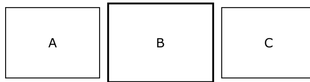
Abbildung 3.5: Drei virtuelle Oberflächen, wobei nur die mittlere auf dem Bildschirm angezeigt wird
