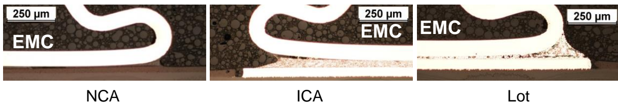
Abb.8.1.1-3: Repräsentative Querschliffaufnahmen zur Bewertung der Benetzung der Fügemedien NCA, ICA und Lot am C-Profil-Federkontakt.
