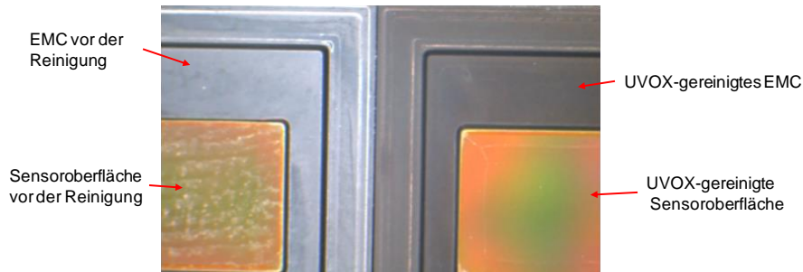
Abb.5.4-5: Vergleich der EMC- und Sensoroberfläche vor und nach der UVOX-Reinigung bei einem Einrichtbauteil für den FAM-Prozess.
