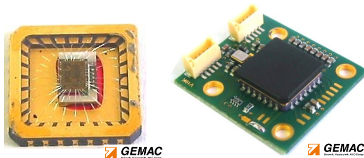
Abb.5.3.1-2: In Keramikgehäuse gehauster Inertialsensoraufbau, so von der AMAC GmbH vertrieben.
