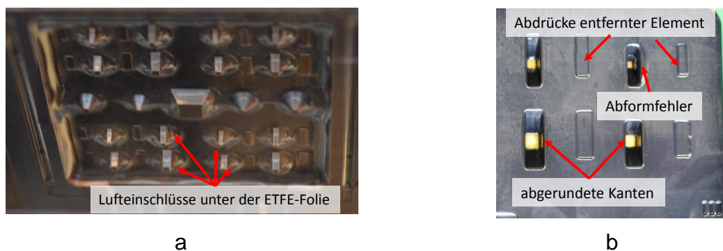
Abb.8.1.2-3: a) Zeigt das ins Werkzeug eingebaute optimierte Insert mit den Freistellungselementen und der darüber gelegten ETFE-Folie und b) zeigt die Abformung der Freistellungselemente im EMC nach dem FAM-Prozess.
