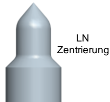
Abb.4.3.2-2: Funktionsausschnitte eines Zentrierstifts zum Aufnehmen des LN für den WT.
