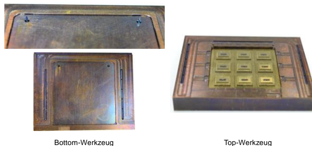
Abb.4.3.2-8: Zusammengebaute Bottom- und Top-Werkzeugeinsätze.
