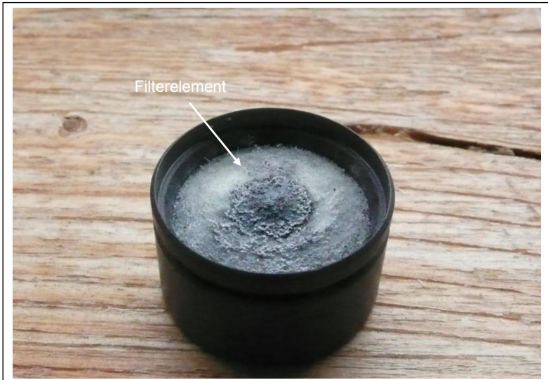
Abbildung 6.3: Beladenes Filterelement nach durchgeführter Partikelmessung
