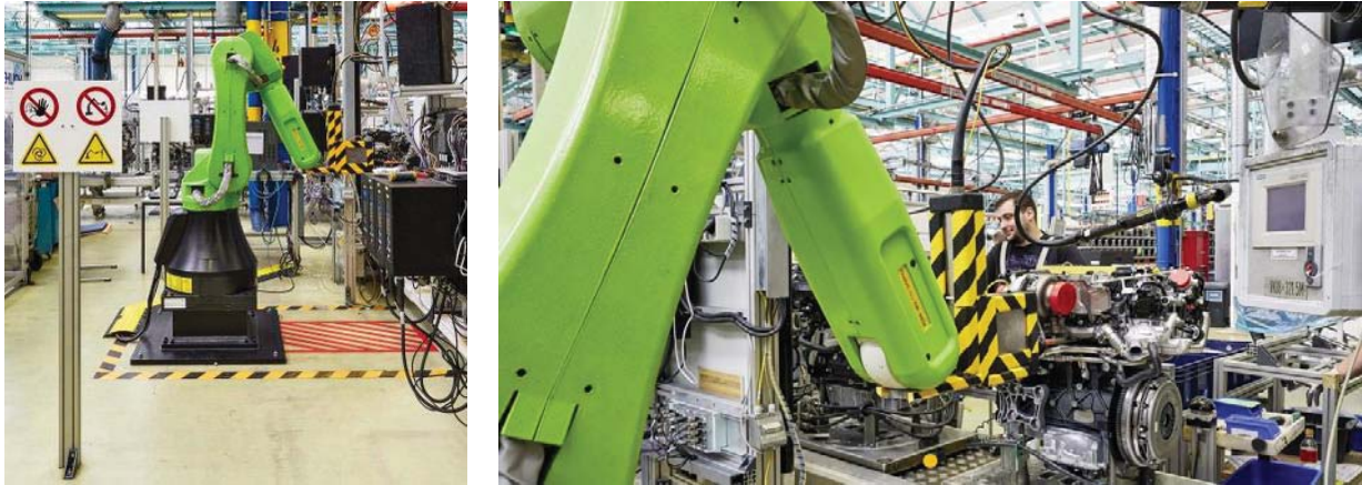
Abbildung 2.12: Kollaborativer Roboter in der Motormontage im Opel Werk Kaiserslautern (Opel Automobile GmbH 2016)
