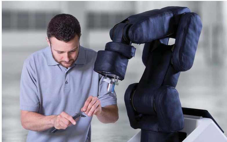
Abbildung 2.10: Kollaborativer Roboter Bosch APAS mit sensibler Schutzhaut (Robert Bosch GmbH 2016)
