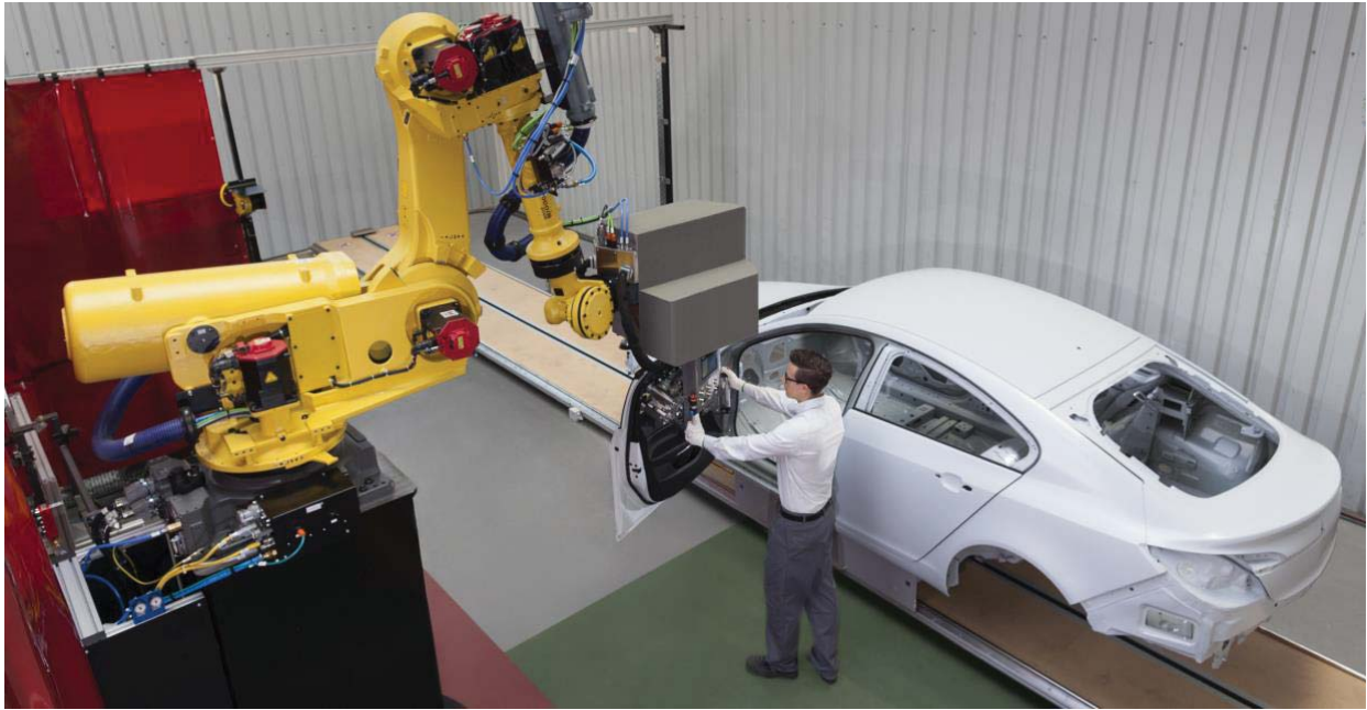
Abbildung 5.9: Türmontage in Mensch-Roboter-Kooperation
