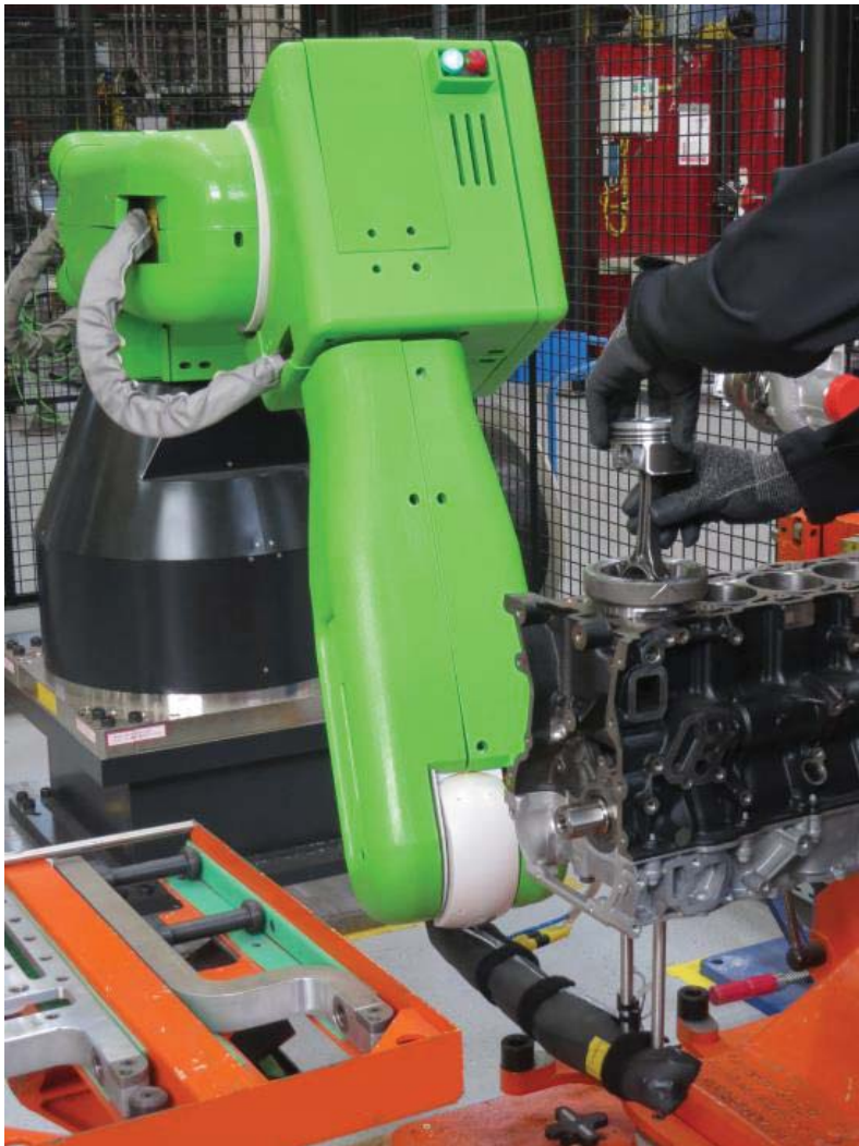
Abbildung 5.13: Der Roboter unterstützt den Menschen in der Kolben-Montage
