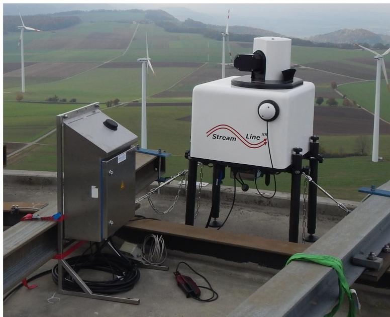
**Abbildung 3.4:** Long-Range Lidar: Stream Line XR
