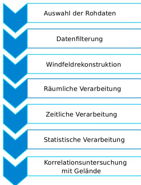
**Abbildung 4.1:** Vorgehensweise bei der statistischen Auswertung der Lidar-daten in Hinblick auf lokale Geschwindigkeitsänderungen
