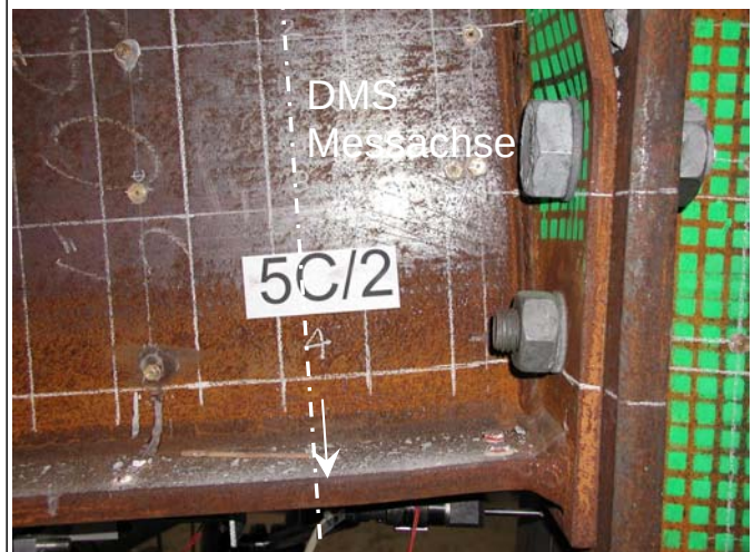
Bild 3.64: Ausbeulen des unteren Rieglflansches
