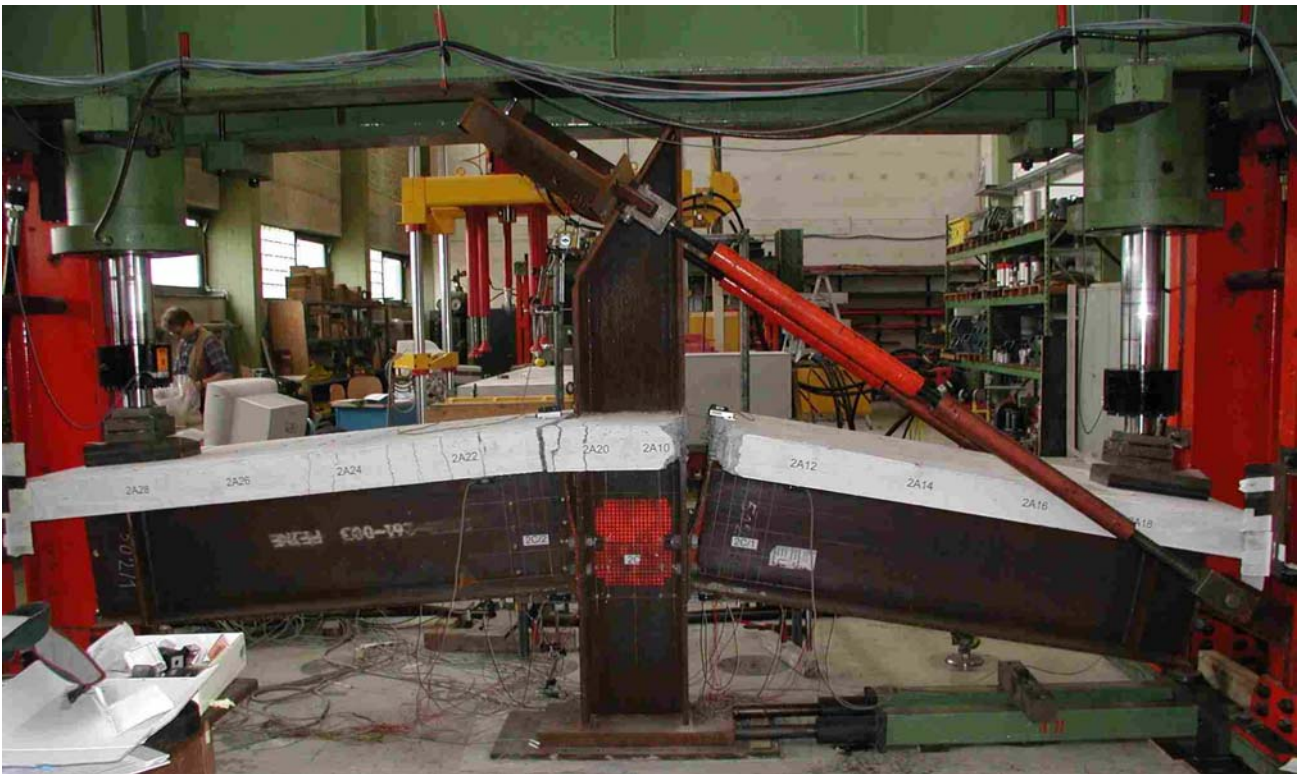
Bild 3.5: Versuchsende bei großer Verformung
