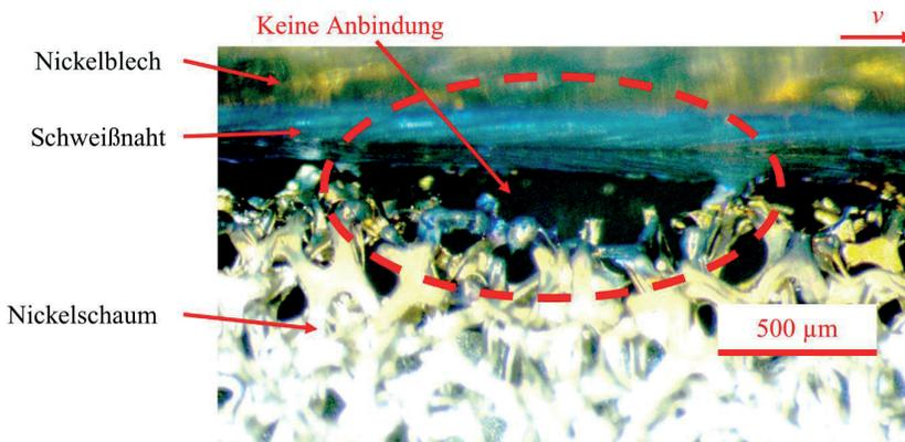
**Bild 2.19:** Mikroskopaufnahme der Fugestelle zwischen Nickelschaum und Nickelblech einer geschweißten Probe. Gleiche Perspektive wie HS-Kamera (siehe Bild 2.17). Parameter:  $v = 9,48$  m/min;  $P_L = 850$  W;  $\lambda_{\text{Laser}} = 1,03$   $\mu\text{m}$ ;  $d_f = 300$   $\mu\text{m}$ ;  $z_f = 0$  mm;  $M^2 = 15$ ;  $s_{\text{Ni}} = 0,3$  mm;  $b_{\text{Schaum}} = 0,135$  mm.
