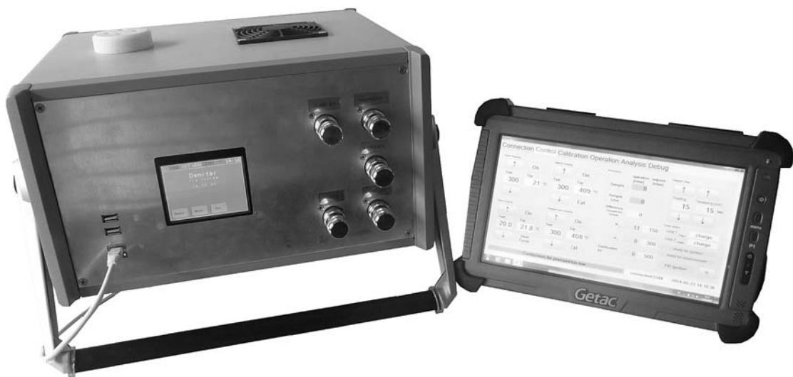
Abbildung D.1: Frontansicht des in der Arbeit weiterentwickelten und für die experimentellen Untersuchungen der Arbeit verwendeten Messgeräts (Prototyp) mit externem, berührungsempfindlichem Eingabegerät (Industrie Tablet) mit aktiver Betriebs- und Auswertesoftware
