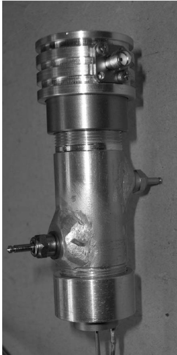
Abbildung D.3: Foto des im Messgerät verbauten Flammenionisationsdetektors
