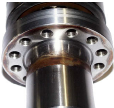
Bild 1.1: Reibdauerbeanspruchung an einer Welle nach Demontage der Nabe
