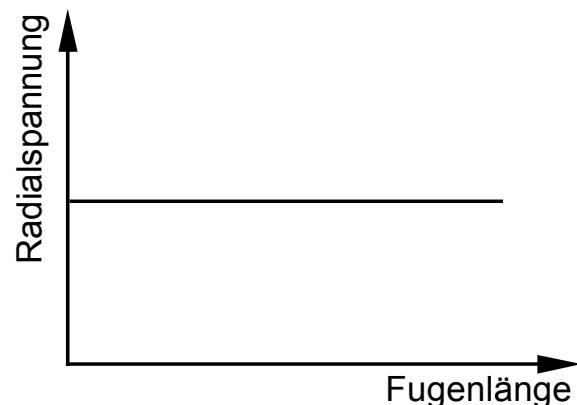
Bild 8.3: Radialspannungen einer spannungsoptimierten Pressfläche
