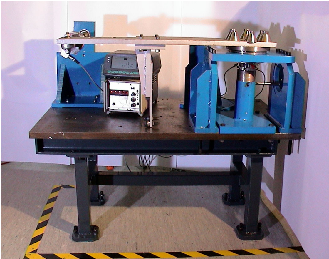
Bild 6.26: Gesamte Messvorrichtung für die Schlupfmessung
