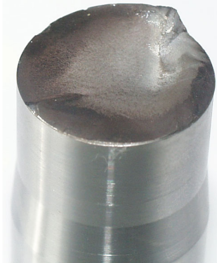
Bild 3.2: RDB-Bruchfläche mit Nase an einer gebrochenen Welle
