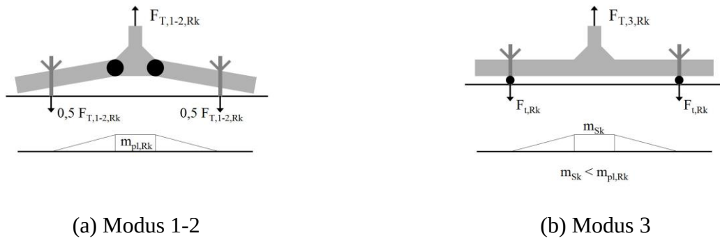
Abbildung 2-19: Versagensmodi von T-Stummeln unter Zug ohne Abstützkräfte
