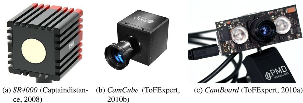
Abbildung 4.3: Tiefenbildkameras mit Messung der Phasenverschiebung, von verschiedenen Herstellern
