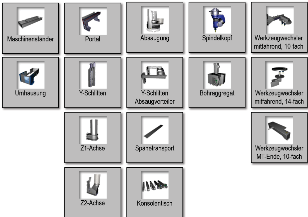
Abbildung 7-2: Funktionsbaugruppen (CPS) der Kommissionierungsliste von Maschine 1
