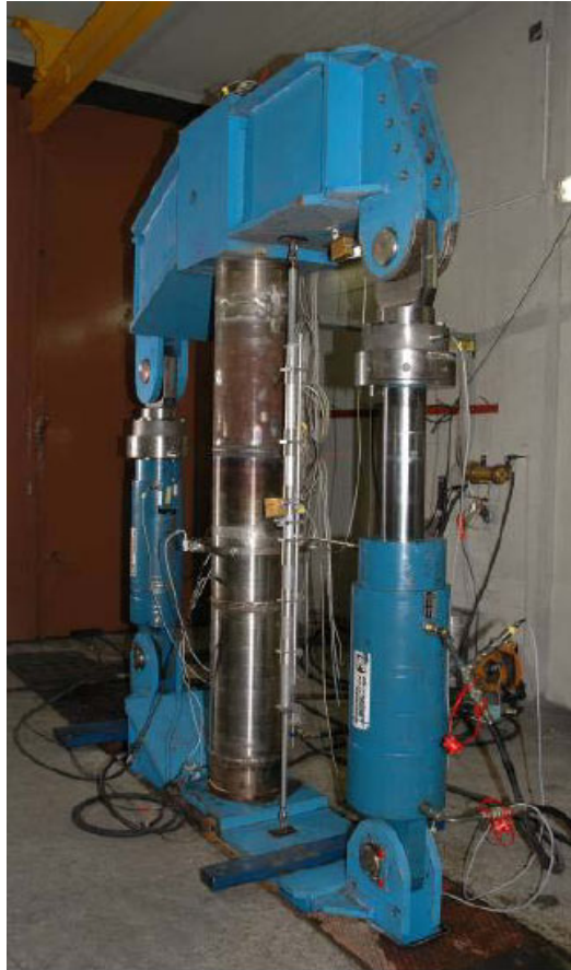
Bild 5.9: Versuch der Nennweite 300 in 2MNm-Biegevorrichtung, ABV301 aus /7/,
