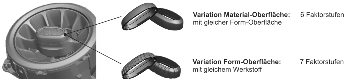
Bild 5.1: Ein Versuchsobjekt und die variierte Oberfläche des Griffelements – VR1
