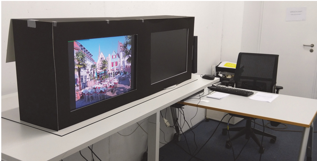
Abbildung 5.11: Versuchsaufbau zur Bewertung der wahrgenommenen Bildqualität
