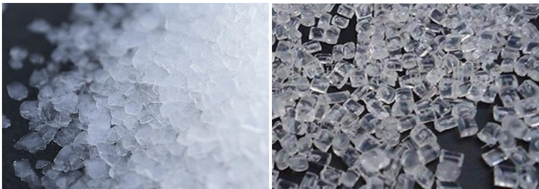
Abbildung 6.3 Füllmaterialien: Aerogel-Granulat (links), Polycarbonat-Granulat (rechts)
