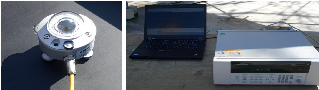
Abbildung 6.4 Pyranometer vom Typ CM 11 des Herstellers ‚Kipp und Zonen‘
