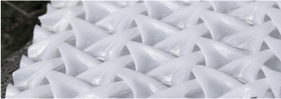
Abbildung 3.16 Formstabilisierung durch die Infusion von Epoxidharz
