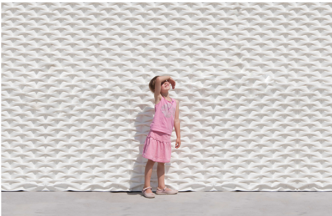
Abbildung 7.3 Faltstrukturen in der textilen Gebäudehülle / PVC-PES-Prototypenmuster im Maßstab 1:1
