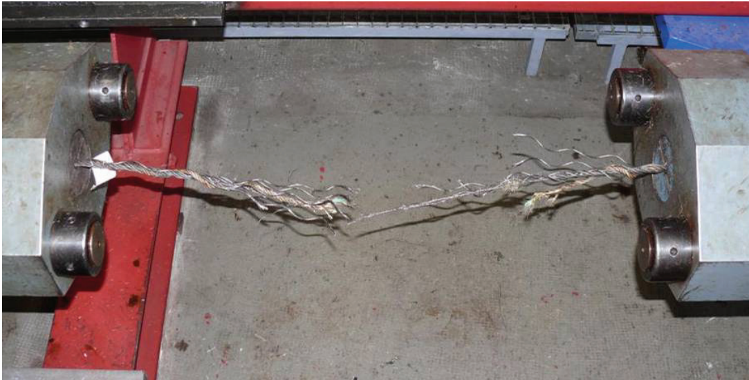
Bild 4.30: Zerreiversuch an einer ausgewählten, vorgeschädigten Seilprobe
