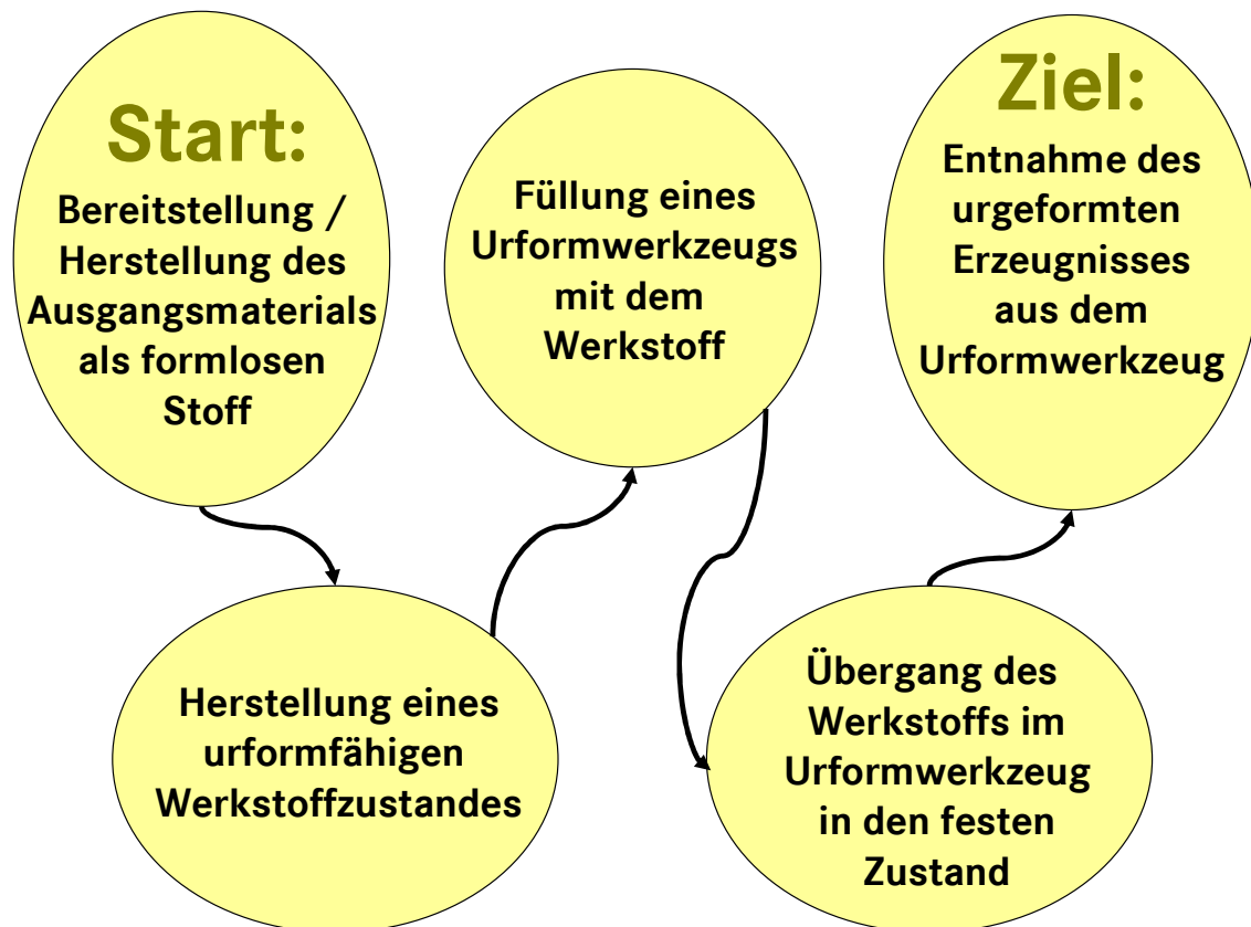
Abbildung 13: Verfahrensprinzip beim Urformen nach [DUB-05]
