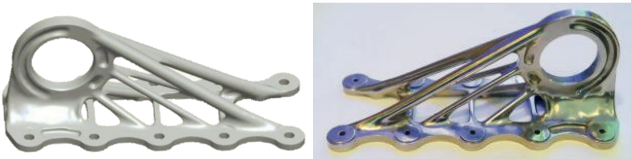
Bild 3.26: Optimierter Kabinenhalter nach [KRANZ17, S. 237] und [BAUER16, S. 9]
