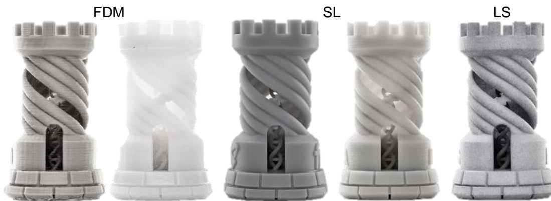
Bild 3.23: Hinterschnitte in FDM, SL und LS nach [FORMLABS18]
