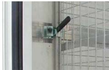
Befestigung der Regalmodule im Fahrzeug
