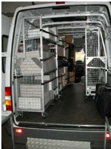
An die Fahrzeugkontur angepasste Regalmodule
