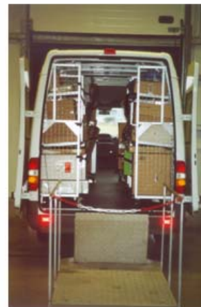
Beladen des Fahrzeugs mittels Scherenhubtisch
