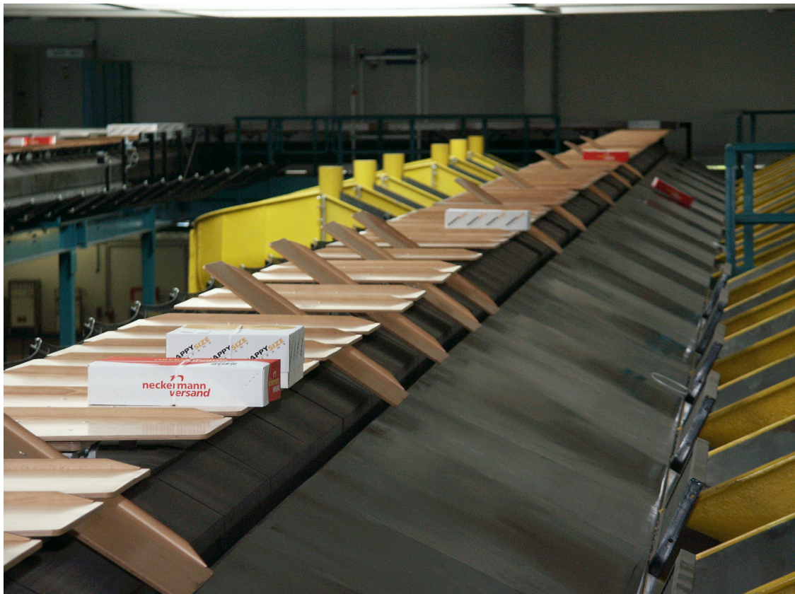
Abbildung 20: Pakete auf dem Warenausgangssorter (Kippschalensorter)
