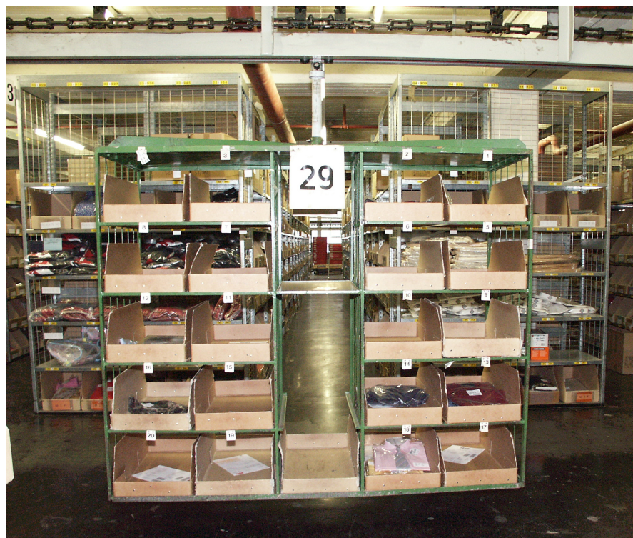
Abbildung 19: Gehänge eines Kreiskettenförderers mit 20 Schalen für Kundensendungen
