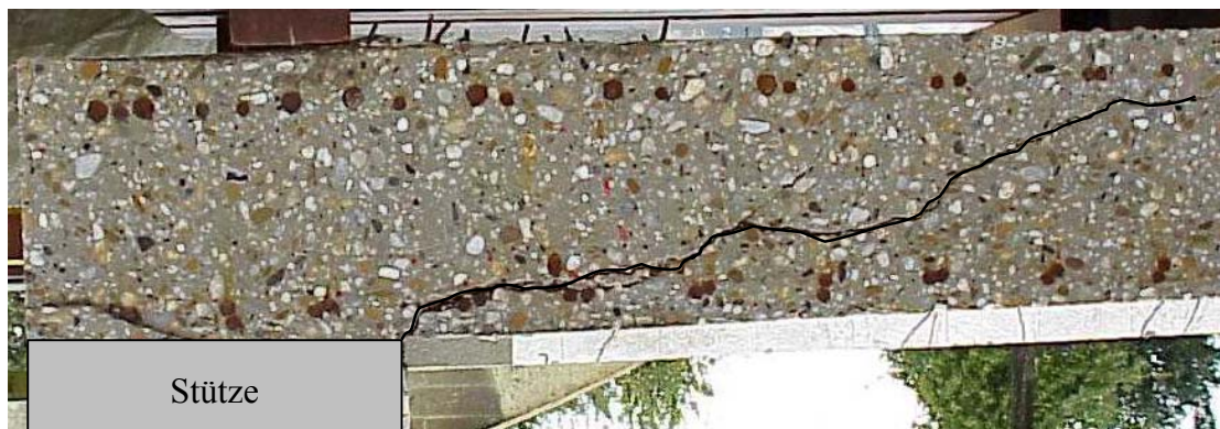
Bild 6.3 Durchstanzriss in einem Sageschnitt senkrecht zum freien Plattenrand
