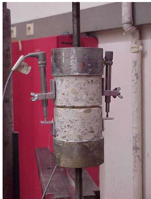
Bild 5.3 Zentrische Zugversuche zur Bestimmung der Bruchenergie
