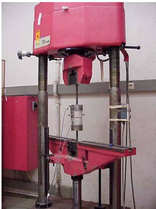
Bild 5.3 Zentrische Zugversuche zur Bestimmung der Bruchenergie
