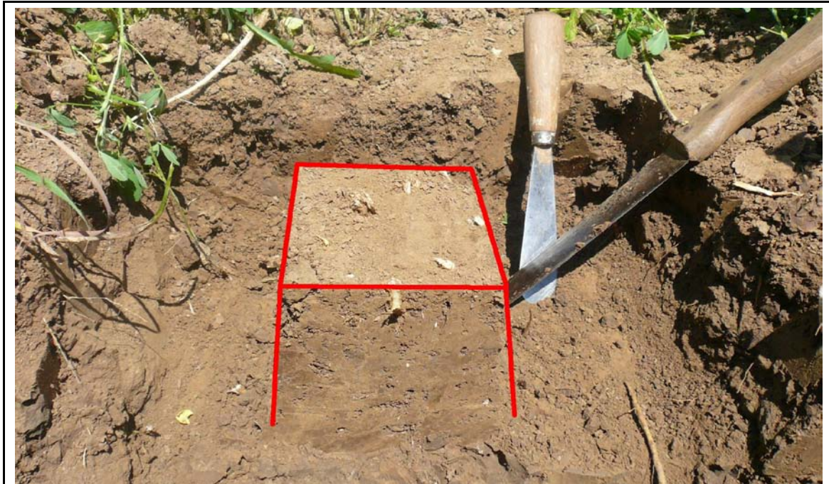
Abbildung 8: Entnahme von Wurzelproben. Mit Hilfe von Messer und Spachtel werden anhand einer Form vorsichtig Quader herausmodelliert, die dann im Labor weiter untersucht werden. (DENGLER 2008)
