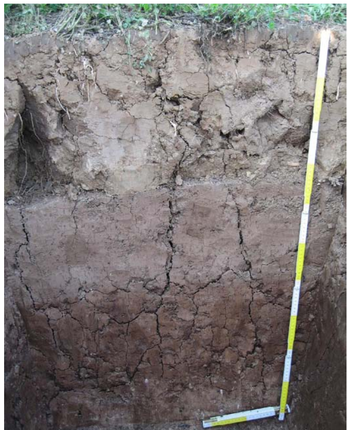
Abbildung 19: Profil vom September 2007. Erkennbar sind der scharfe Übergang jY-fAp mit Wurzelfilz und die dicht gelagerten jY- und Ap-Horizonte. (KÖSEL 2007)
