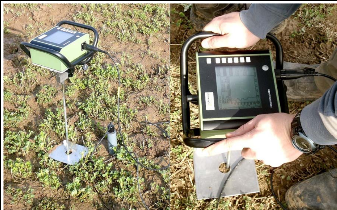
Abbildung 7: Bedienung des Penetrologger: Mithilfe der Libelle wird das Gerät senkrecht und mit gleichbleibender Geschwindigkeit von 2 cm/s in den Boden gedrückt. Dabei misst ein Ultraschallsensor den Abstand zur auf dem Boden liegenden Metallplatte, die der Reflektion der Ultraschallwellen dient, und hilft so, die Geschwindigkeit zu regulieren. Der optional per Kabel anzuschließende Feuchtesensor (linkes Bild, neben der Metallplatte) misst den volumetrischen Wassergehalt. Auf dem Display werden die gemessenen Werte numerisch oder grafisch (rechts) angezeigt, so dass schon im Feld eine erste Beurteilung möglich ist. Vor den Feldarbeiten ist jedoch das Erstellen eines Untersuchungsplanes notwendig, nach dem die einzelnen Messungen dann durchgeführt werden. Das Erstellen des Planes sowie die Beurteilung der Messergebnisse kann mithilfe beiliegender Software am PC erfolgen. (Fotos: links: DENGLER 2008; rechts: EBERLE 2008)
