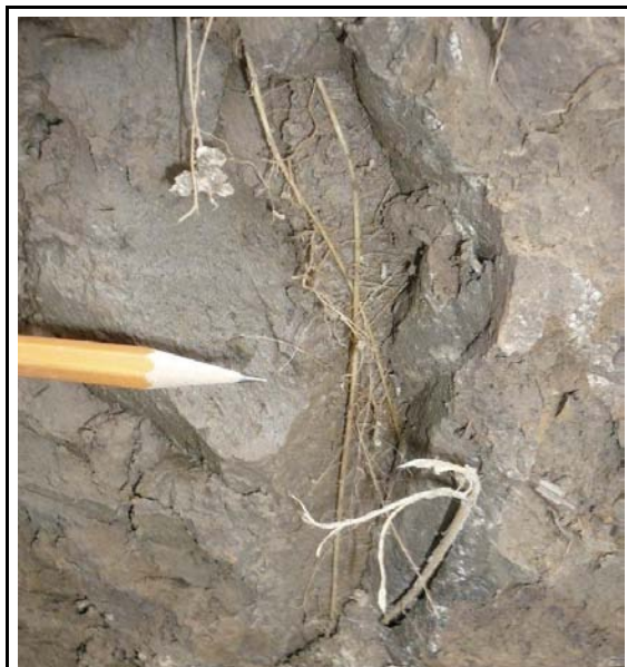
Abbildung 11: Wurzeln entlang von Rissen. In A-01 wurde dies im 35 cm mächtigen Auffüllhorizont in ca. 20 cm Tiefe fotografiert. (DENGLER 2008)
