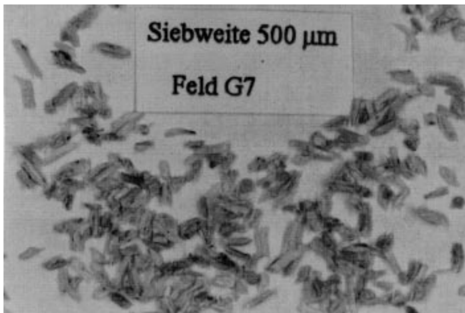
Bild 7.9: Partikel aus dem Feld G7 mit maximal 500 µm Größe
