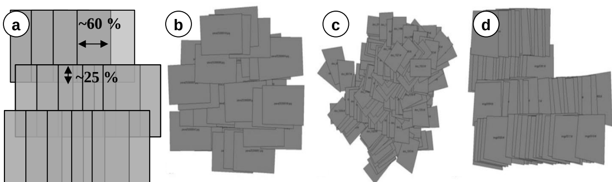
Abb. 5.1: (a) Klassischer Bildverband mit etwa 60 % Längs- und 25 % Querüberdeckung für eine Bündelblockausgleichung und realistische schematische UAV-Bildverbände mit unterschiedlicher Qualität des Luftbildblocks durch manuelle (b) und automatische Befliegungen mit Low-Cost- (c) und High-End- (d) Navigationssystem (Nex und Remondino, 2014).
