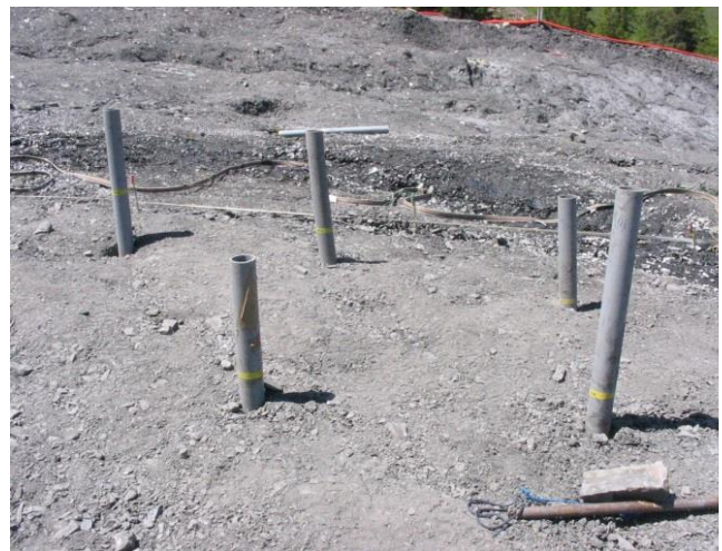
Abb. 6.33: Fünf Kunststoffrohre mit versenkten Längen von 1 m, 1,5 m, 2 m, 2,5 m und 3 m zur Beobachtung von Deformation in der Messkampagne 2010.
