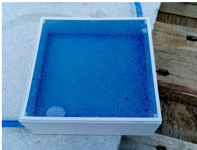
Abbildung 94. Glasblasenbildung an der unteren Seite der Abdeckungen des Versuchsreaktors.
