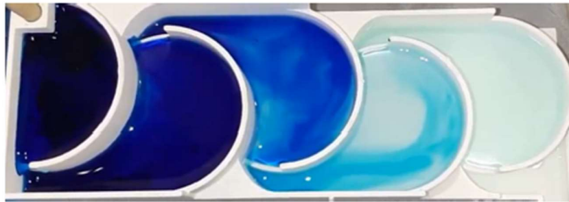
Abbildung 122. Visualisierung der Strömungsverhältnisse mit Methylenblau im Reaktor Typ 3.
