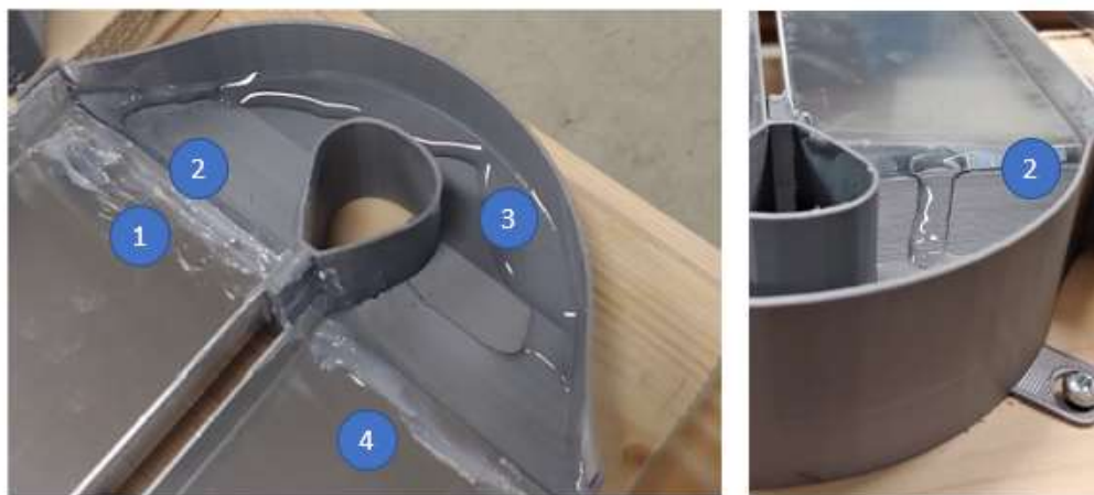
Abbildung 96. Höhenlevel in dem Verbindungselement beim Durchfluss von Wasser (links) und der Stauwasserstand am Profilende verursacht durch die Oberflächenspannung oberhalb des Wehres.
