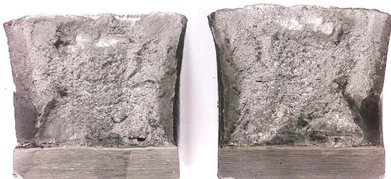
Bild 4.79: Kerbschlagbiegeprobe aus dem Interface der Nickel-Basis Pufferung P2, Kerbschlagarbeit 90 J
