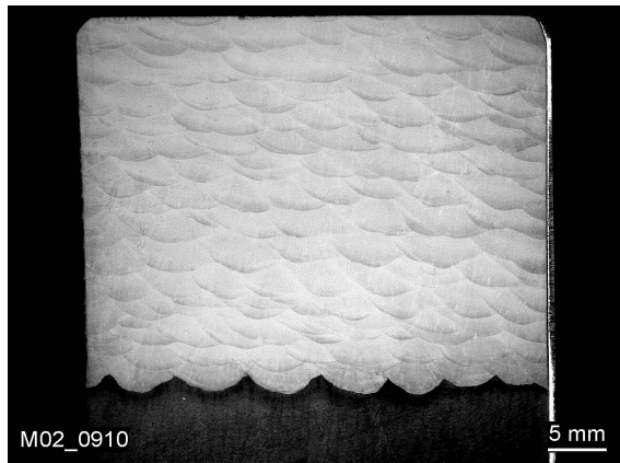
Bild 4.34 : Pufferung P2 mit Nickel-Basis Elektrode geschweißt
