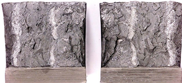
Bild 4.71: Kerbschlagbiegeprobe aus dem Interface der austenitischen Pufferung P1, Kerbschlagarbeit 28 J
