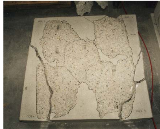
Bild 5.91: Ausbruchfigur der Ankerschienen ( \bar{u} = 300 mm)
