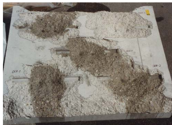
Bild 5.95: Bruchfigur der Ankerschienen
