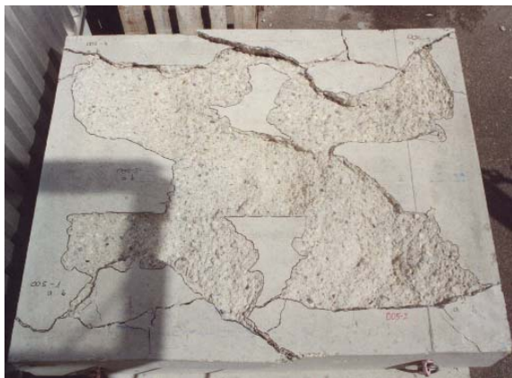
Bild 5.94: Ausbruchkegel der Kopfbolzen
