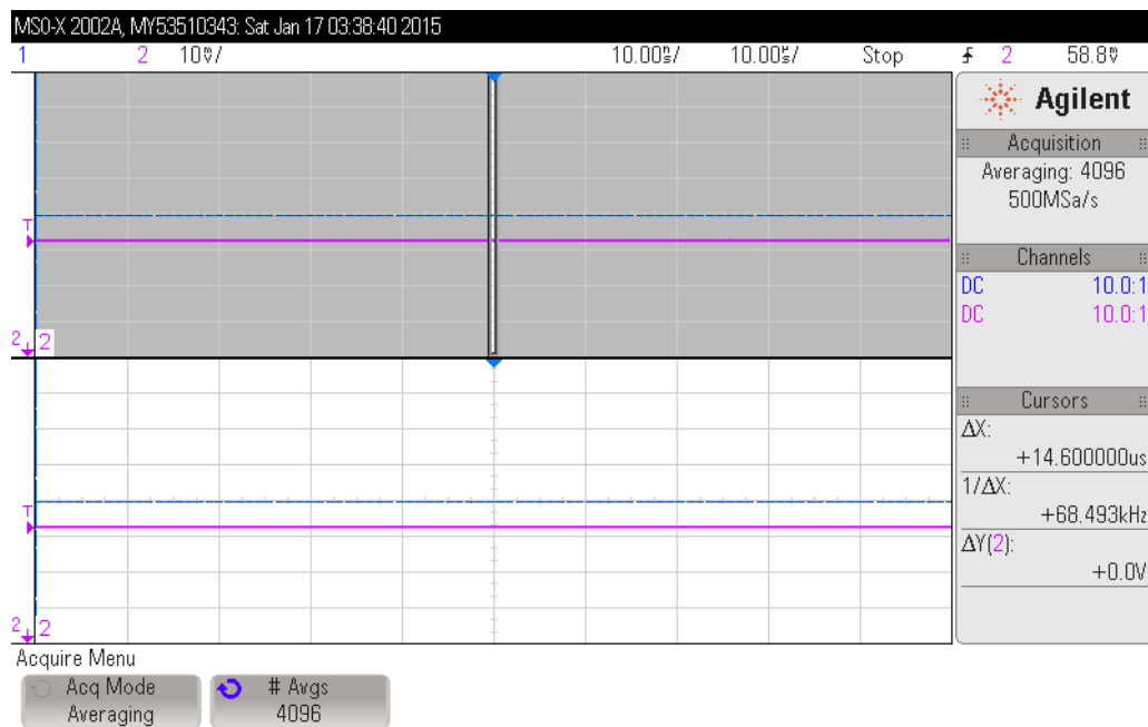
Abb. C.15.: Oszillogramm für den Shunt 0.01\ \Omega am 12V Ausgang (8-pin CPU1) des Schaltnetztes Antec EartWatts EA-450 mit angeschlossenem Hochlast-Widerstand 2.2\ \Omega . Der Oszilloskop Mode ist „Average over 4096 samples“.
