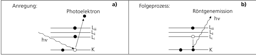
Abbildung 4-2: Physikalisches Prinzip der Röntgenfluoreszenz /Dörffel 2004/ a) Herauslösen eines Photoelektrons durch Röntgenstrahlung b) Emission von Röntgenstrahlung durch Sprung eines Elektrons des höheren Orbitals in die Leerstelle
