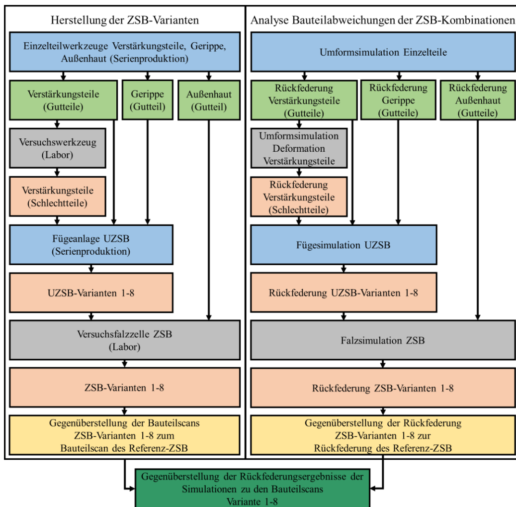
Abb. 6-1: Herstellungsprozess der ZSB-Varianten für den Abgleich der Rückfederungsergebnisse mit der jeweiligen PKS.
