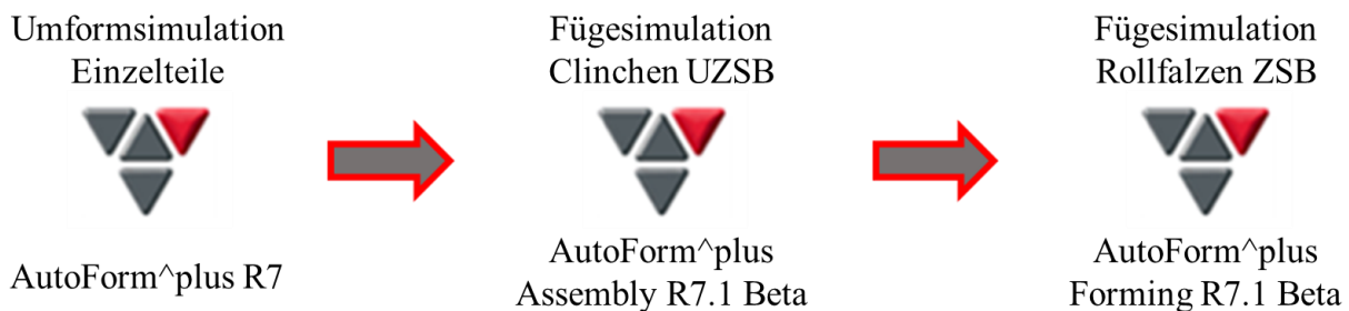
Abb. 4-2: Verwendete Software zur Modellierung der Prozesskette des Herstellungsprozesses der untersuchten Motorhauben von der Umformsimulation der Einzelteile bis zur Falzsimulation des ZSB.
