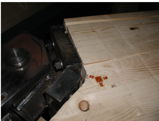
(a) abgeplatzt Holz
