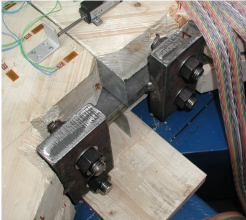
Abbildung 5.23: Im Druckbereich in den Gehrungsschnitt eingeschobene Bleche
