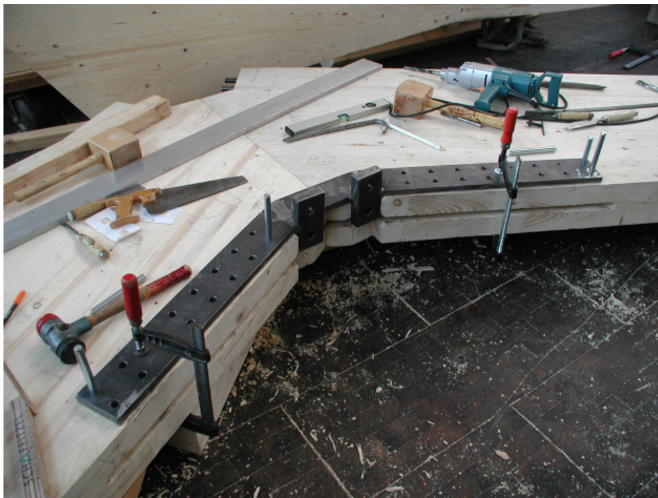
Abbildung 5.11: Schlitzblech als Bohrschablone für die Stabdübellöcher
