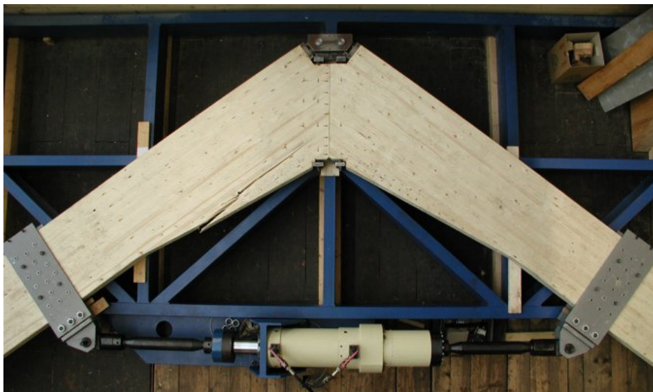
Abbildung 5.1: Prüfstand mit Rahmenecke
