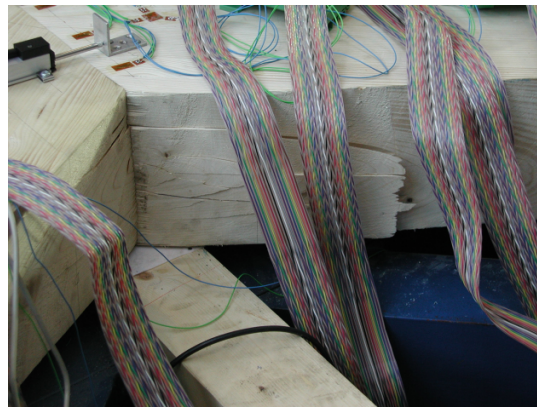
(b) Abplatzen des ersten Lamellenstücks im Druckbereich
