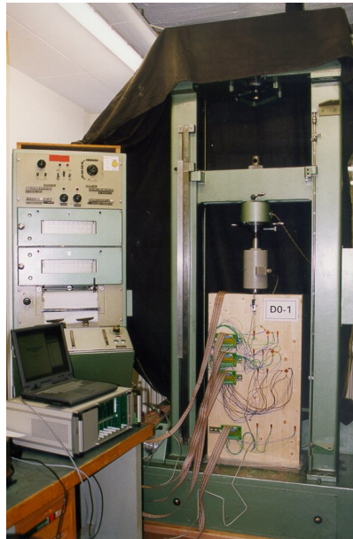
Abbildung 3.1: Versuchskörper in Prüfmaschine
