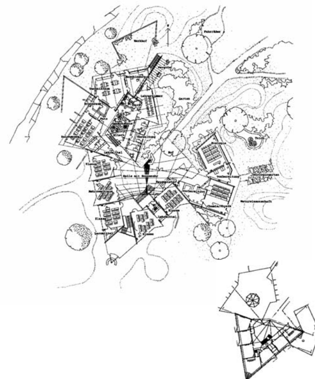
Schule Lorch „Auf dem Schäfersfeld“ (1978-1982) Die maßgebliche Geometrie der zentrumsorientierten Schule ist das Dreieck. Charakteristisches, äußeres Merkmal des Gebäudes ist die weit auskragende Südspitze. →Vgl. Niemeyer, Haus Deyhle (1969)
