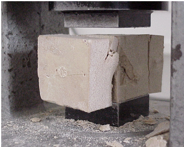
Bild 4.1 Versagen des Injektionssystems HH nach Druckfestigkeitsbeanspruchung
