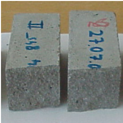
Bild 4.4 Bruchflächen des Zement-Systems PZ nach Druckfestigkeitsprüfung
