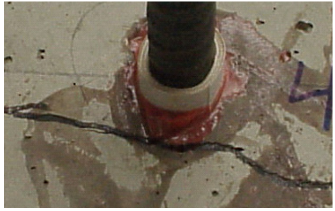
Bild 4.108 Typische Rissverläufe bei Montage der Bewehrungsstäbe im ungerissenen Beton und Öffnen der Risse auf w = 0,5 \text{ mm} ( w_{05} ); d_s = 20 \text{ mm} , l_v = 8 d_s ; (System HE)
