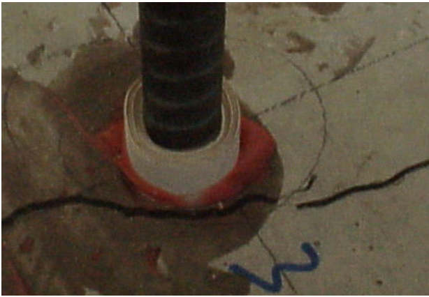
Bild 4.108 Typische Rissverläufe bei Montage der Bewehrungsstäbe im ungerissenen Beton und Öffnen der Risse auf w = 0,5 \text{ mm} ( w_{05} ); d_s = 20 \text{ mm} , l_v = 8 d_s ; (System HE)
