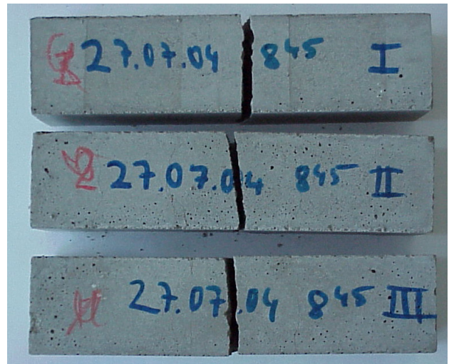
Bild 4.4 Bruchflächen des Zement-Systems PZ nach Druckfestigkeitsprüfung
