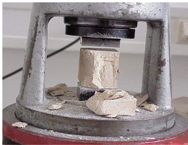
Bild 4.1 Versagen des Injektionssystems HH nach Druckfestigkeitsbeanspruchung
