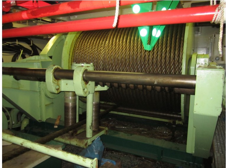
Abb. 85: Spulhilfe mit Kreuzgewindespindel einer Schleppwinde
