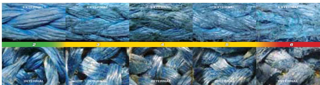
Abb. 46: Auszug aus Pocket Guide für AmSteel Blue von Samson Ropes (oben Seilzustand außen, unten Seilzustand im Innern) [Sam13]
