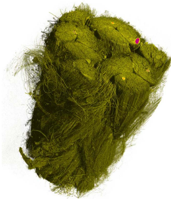
Abb. 30: Computertomografie-Aufnahme eines Faserseiles [Sch14-2]
