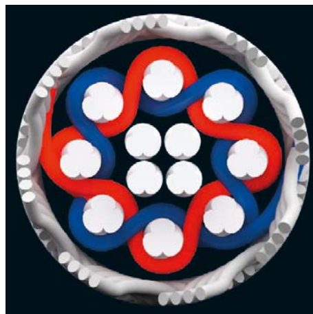
Abb. 20: Prinzipdarstellung der Platinum-Technologie von Teufelberger (Rot und Blau Verbindungsfäden) [Teu12]
