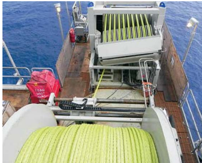
Abb. 49: Spillwinde mit hochmodularem Faserseil [Boe15]
