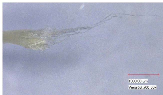
Abb. 33: Bruchende HMPE (Einzelne lange Faserbruchenden) [Wol15]
