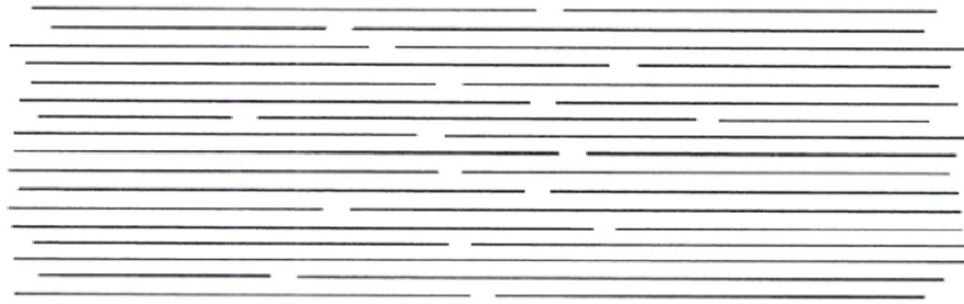
Abb. 2: Ideale Molekülstruktur eines hochmodularen Faserseiles [McK04]
