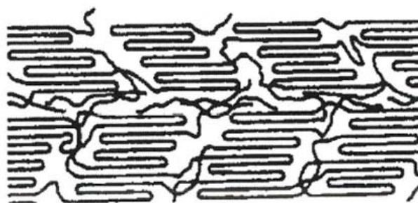
Abb. 1: Molekülstruktur eines niederfesten Faserwerkstoffes [McK04]
