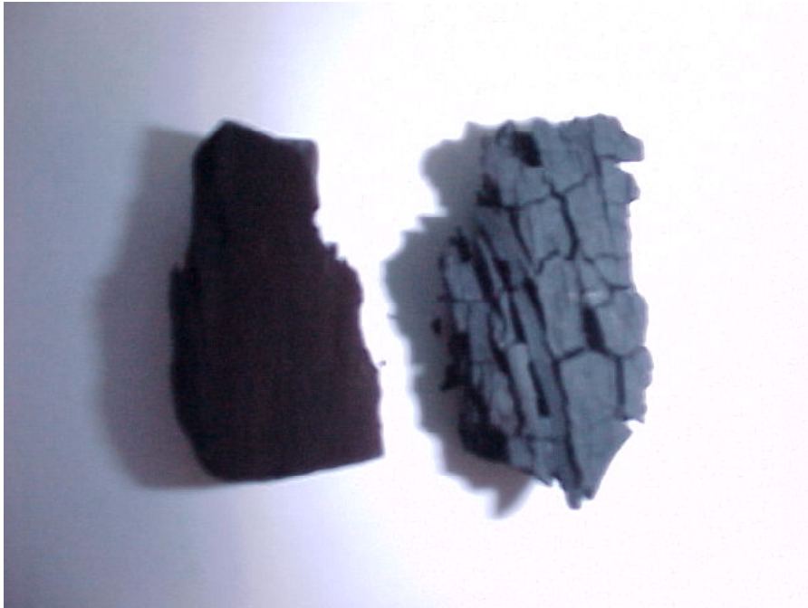
Abb. 6.14: Vergleich von normal und CO 2 -getrockneter rumänischer Braunkohle
