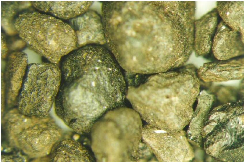
Abb. 6.10: Bulgarische Trockenbraunkohle aus der Wirbelschicht
