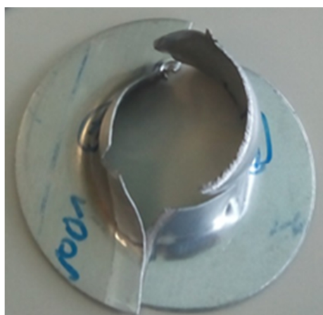
Abbildung 3.6: Bruchverhalten in Zug- (oben) und Umformversuchen (unten) der Materialkombination HX340LAD+Z und EN AW 6016 T4
