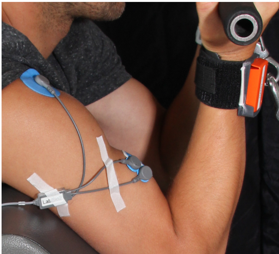
Abbildung 13: Anbringung des Beschleunigungssensors (XSens Mtw, orange) und der EMG-Elektroden am rechten M. Bizeps brachii bei der Übung Bizepscurl. Der Seilzugpotentiometer war an den Gewichten des Seilzuges befestigt.
