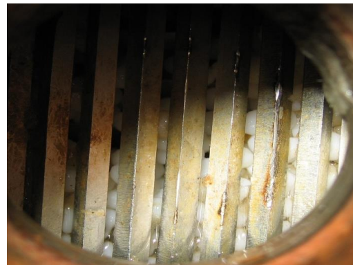
Abb. 6- 52: Verstopfung am Zulaufsieb verursacht durch bei PBSM-Dosierung dosiertes Substrat Aceton (Bild links) und Sieb nach der Reinigung (rechts)
