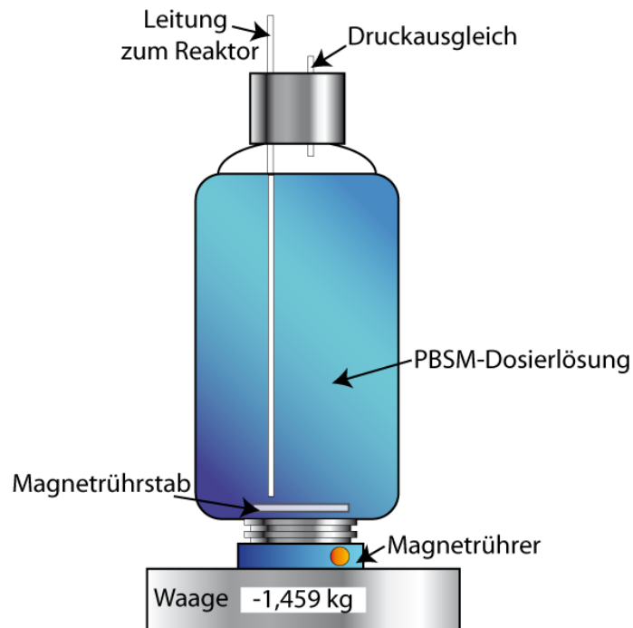
Abb. 5- 4: Details der PBSM-Dosiereinrichtung
