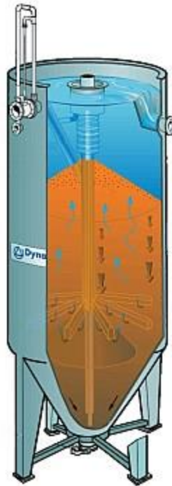
Abb. 4- 4: Schema DynaSand-Filter (Bild zur Verfügung gestellt von Fa. Nordic Water ).
