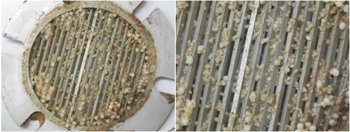
Abb. 6- 49: Neue Siebkonstruktion (links) mit mittleren Spaltenabstand von 1,5 mm, um Granulat möglichst lange am Durchtritt zu hindern (rechts).
