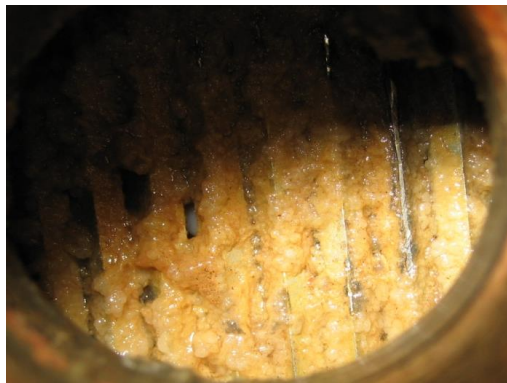
Abb. 6- 52: Verstopfung am Zulaufsieb verursacht durch bei PBSM-Dosierung dosiertes Substrat Aceton (Bild links) und Sieb nach der Reinigung (rechts)
