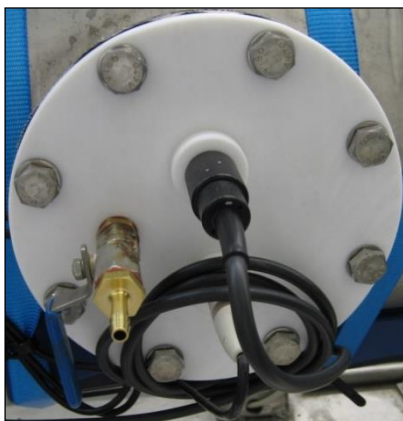
Abb. 5- 7: Detailansicht Messplatte (links), Messung (rechts) mit angeschlossenen Messgeräten (Typ Multiline, Fa. WTW).
