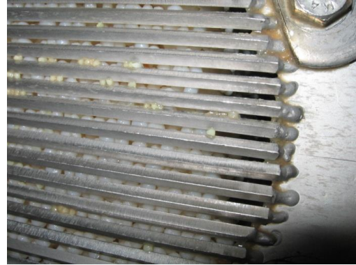
Abb. 6- 51: Korrigierte Siebanordnung (links) und ein dadurch funktionierender Materialdurchtritt bzw. -rückhalt (rechts).
