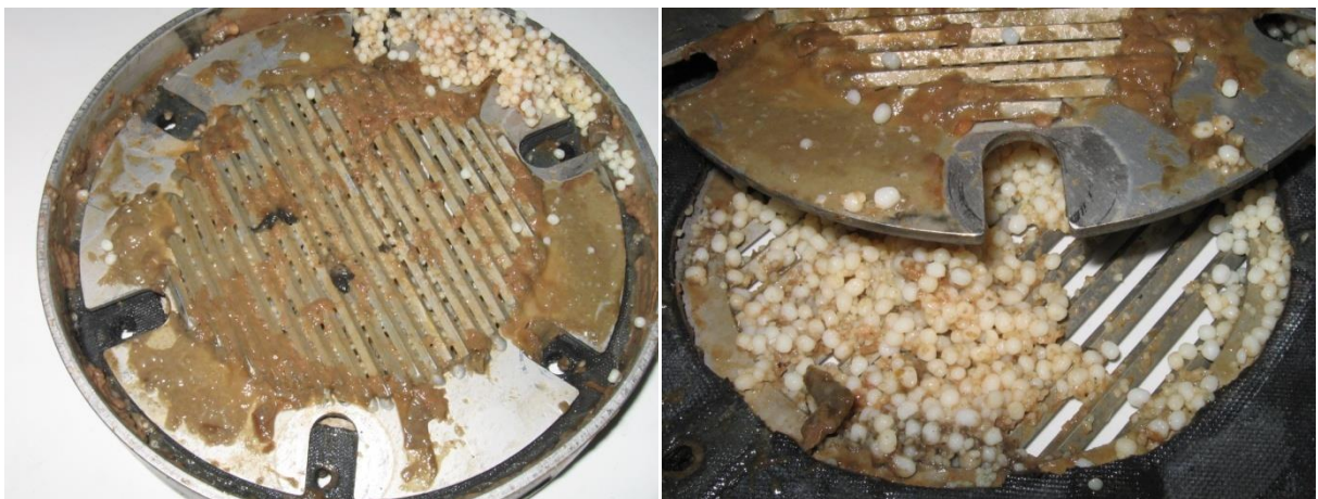
Abb. 6- 50: Die vertauschte Anordnung der Siebe (neues Sieb unterhalb des alten; Bild links), führte zu einer Materialansammlung zwischen beiden Sieben und damit zu regelmäßigen Verstopfungen (rechts).
