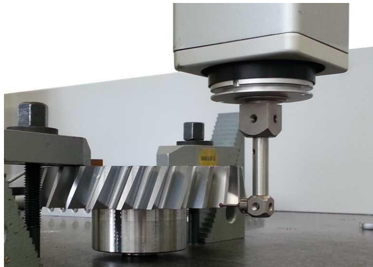
Bild 7.2: Vermessung der Verzahnung mithilfe einer Koordinatenmessmaschine
