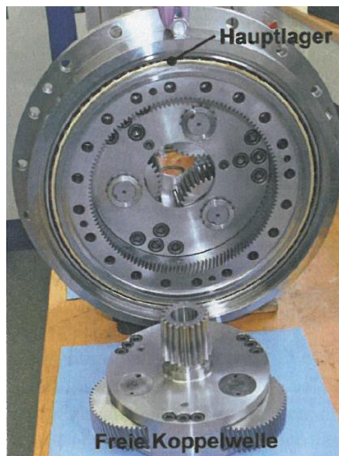
Bild 2.2: Beispiel für eine Beveloid-Planetenstufe in einem Roboterantrieb [HÖHN11, S. 62]
