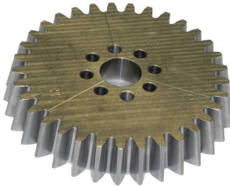
Bild 2.5: Geradverzahntes Beveloidrad mit Profilverschiebungswinkel \theta = 11^\circ
