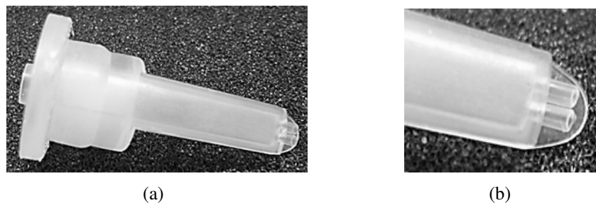
Abbildung 6.9: Tropfaufsatz des Medikaments Novaminsulfon Lichtenstein mit zwei Öffnungen am Luftrohr ( L_2 = 29,7 mm, r_L = 0,45 mm [30]): (a) Tropfaufsatz; (b) Detaillansicht
