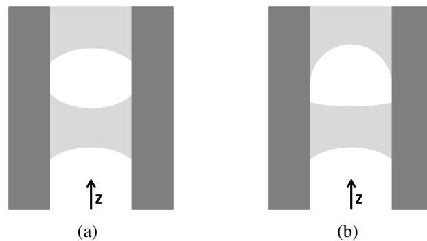
Abbildung 6.3: Schematische Darstellung der Wirkung der Kontaktwinkelhysterese auf eine Blase in der Flüssigkeit im Luftrohr: (a) Blase; (b) Verformte Blase
