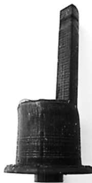
Abbildung 6.7: 3D-gedruckter Senkrechtstropfer, Abmessung analog zu LW-0,6-S2 (vgl. Anhang B.1)
